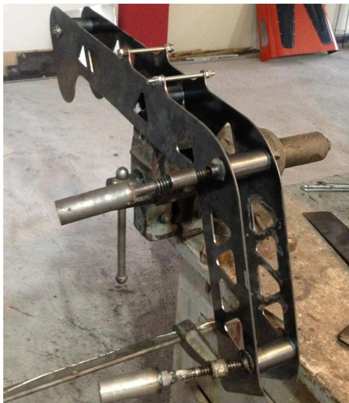
Figura 35 Ensamble de las planchas del bastidor.
