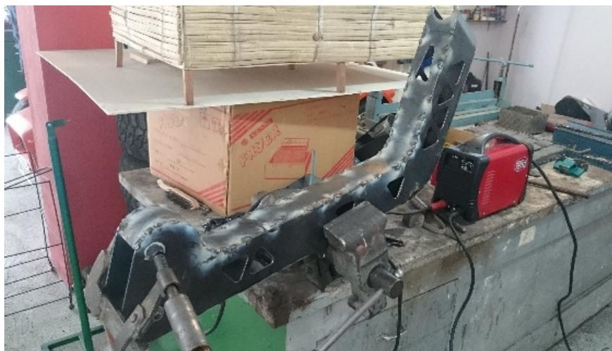
Figura 36 Cordones de soldadura con electrodo E-6013.
