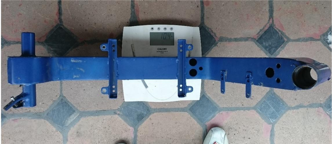
Figura 46 Masa del bastidor original.
