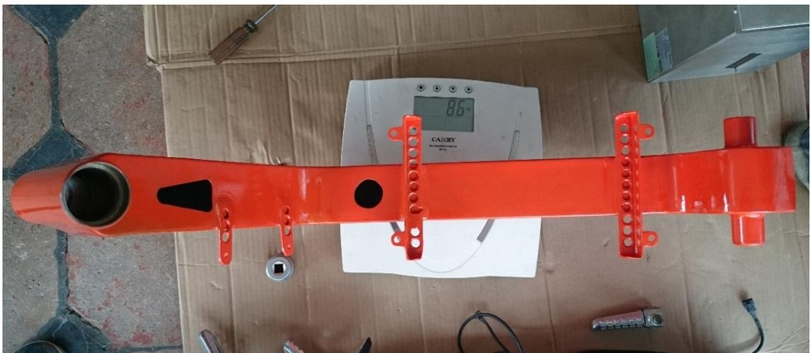
Figura 47 Masa del bastidor optimizado.
