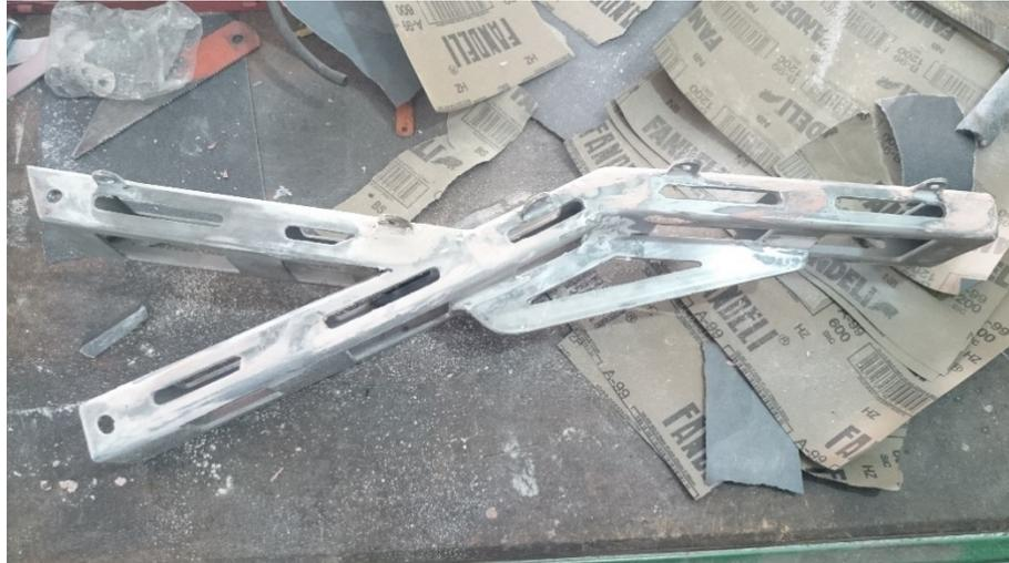
Figura 43 Lijado de componentes.
