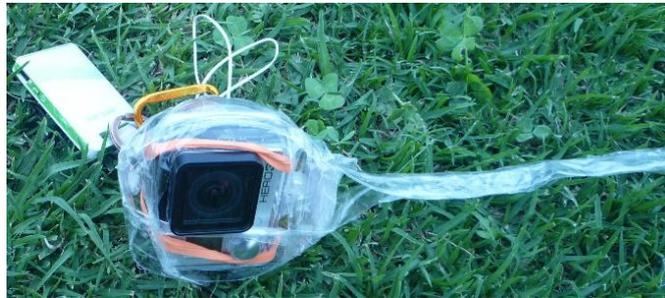
**FIGURA 31. Capsula con el GPS y la cámara.**
