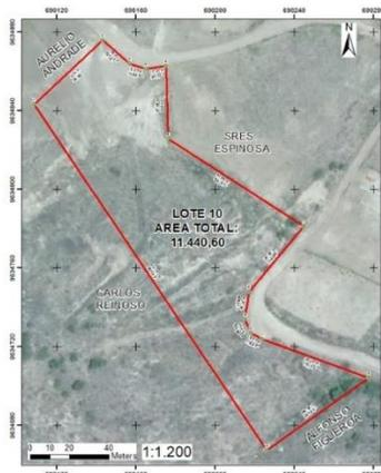
**FIGURA 9. Levantamiento predial usando ortofotografía realizada por el IGM (Instituto Geográfico Militar).**
