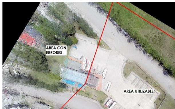
**FIGURA 47. Ejemplo de una ortofoto obtenida en las pruebas con cometas.**
