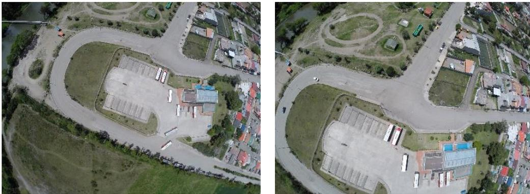
Fotografías del tercer vuelo usando cometas, las fotografías salieron nítidas debido a que la botella que se usó como capsula era pequeña y quedaba a la altura del lente, se configuró la cámara a 12 megapíxeles, se pudo obtener mayor cantidad de imágenes a una altura continua debido a vientos estables, las lecturas del GPS dan resultados valores razonables en las alturas, se tomaron 558 fotografías de las cuales se escogieron 100 que eran las que salieron verticales y a una altura continua.
