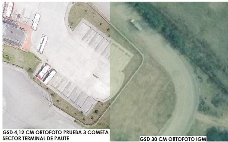
**FIGURA 53.** Ortofoto obtenida desde cometa en la prueba 3 y ortofoto IGM.
