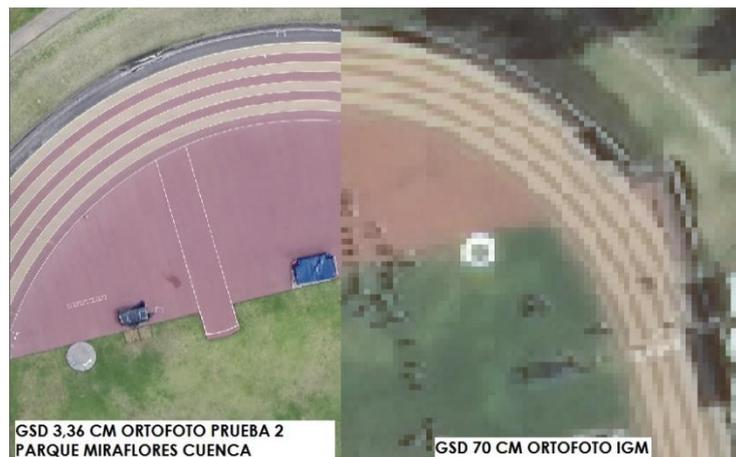
**FIGURA 50.** Ortofoto prueba 2 con dron e vuelo con la primera batería y ortofoto IGM.
