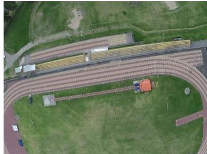
**Fotografías del vuelo con la primera batería se configuró la cámara a 7 megapíxeles y se voló a una altura estimada de 70 metros de altura, se tomaron 1621 fotografías.**
