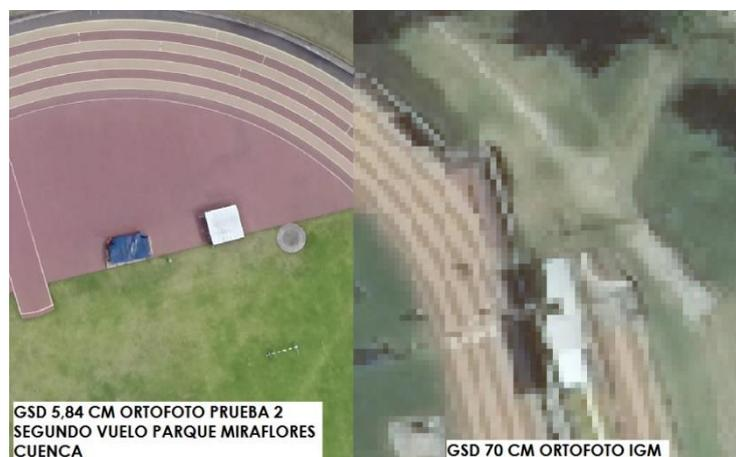
**FIGURA 51.** Ortofoto prueba 2 con dron e vuelo con la segunda batería y ortofoto IGM.
