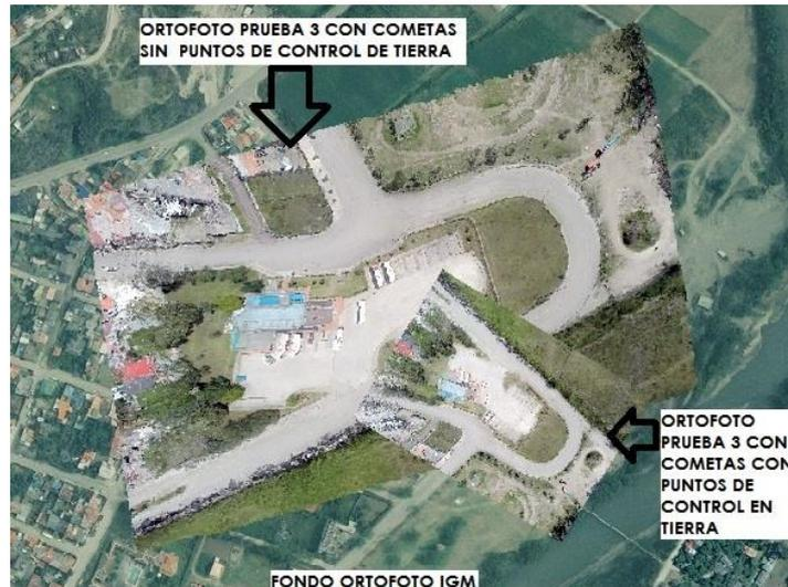
**FIGURA 56. Ortofotos obtenidas en la prueba usando cometas en el terminal de Paute con y sin puntos de control en tierra, superpuestas sobre la ortofoto del IGM.**
