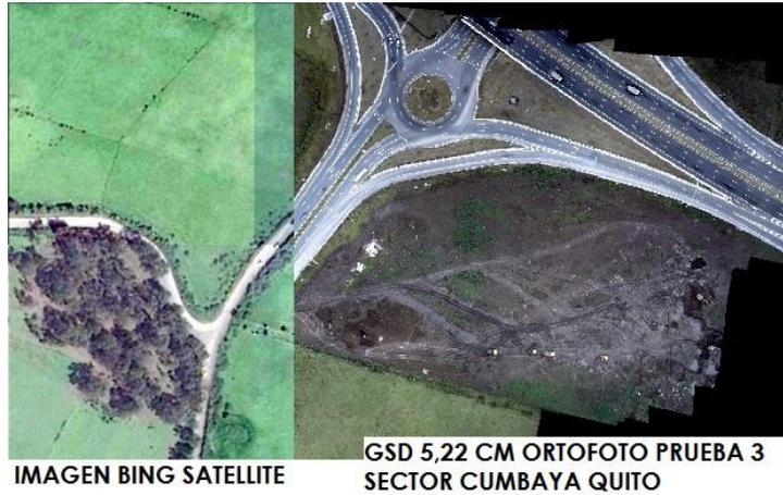
**FIGURA 52.** Ortofoto prueba 3 con drone y la imagen Bing satélite.
