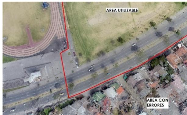
**FIGURA 48. Ejemplo de una ortofoto obtenida en las pruebas con globos.**
