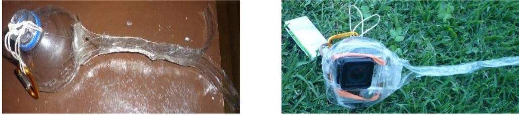
**FIGURA 37. Preparación de la capsula que contendrá la cámara y el GPS.**
