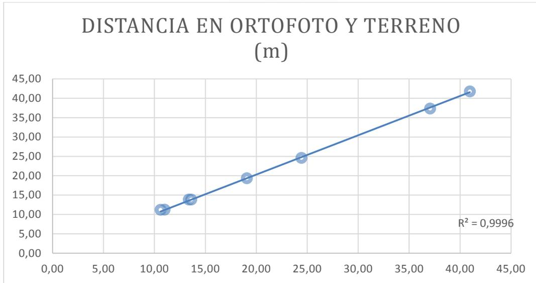
**FIGURA 63. Gráfico de dispersión entre las longitudes tomadas en el terreno y la longitud tomada en la ortofoto obtenida usando cometa.**
