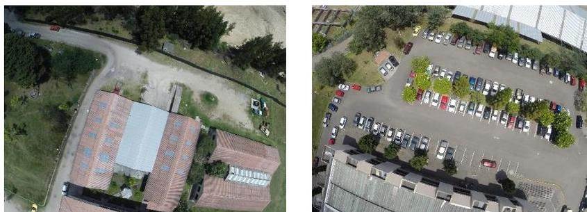
**Fotografías del vuelo, se usaron 4 baterías del Phantom 1 para cubrir el área, se configuró la cámara a 7 megapíxeles, la altura estimada de vuelo fue de 100 metros de altura, se tomaron 1056 fotografías.**
