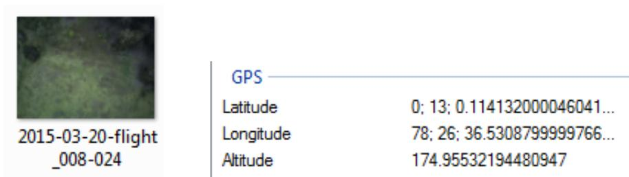
**FIGURA 22. Propiedades de una imagen tomada con el drone Aeryon Scout, las imágenes obtenidas ya están georreferenciadas.**
