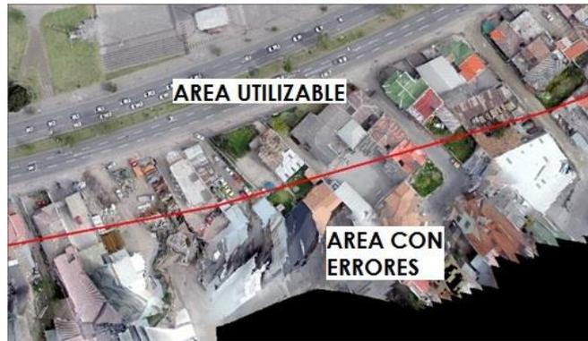
**FIGURA 46. Ejemplo de ortofoto obtenida en las pruebas con drone.**
