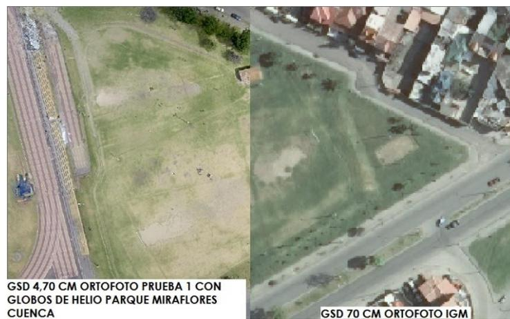
**FIGURA 54.** Ortofoto prueba 1 con globos de helio y ortofoto IGM.
