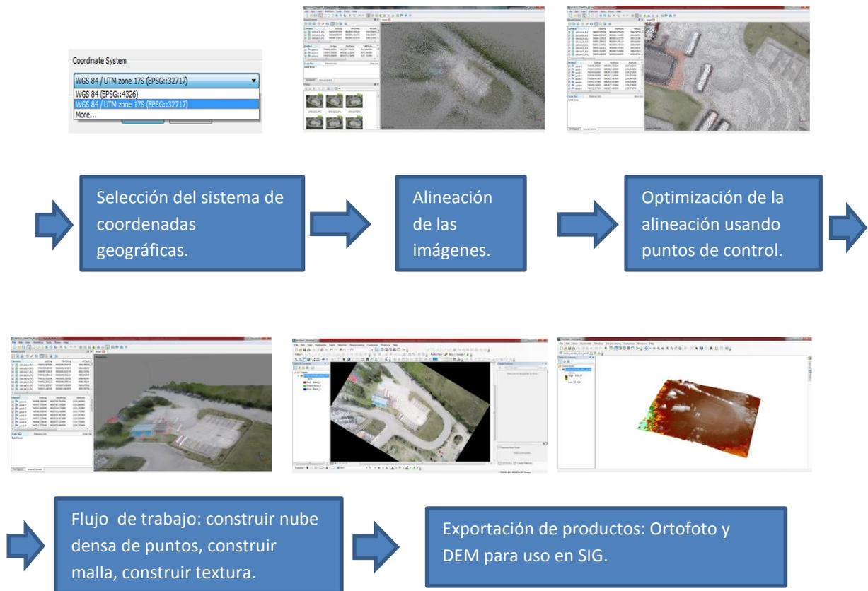
**FIGURA 34. Esquema del procesamiento de imágenes y puntos de control para obtener la ortofotografía y modelo digital de superficie.**
