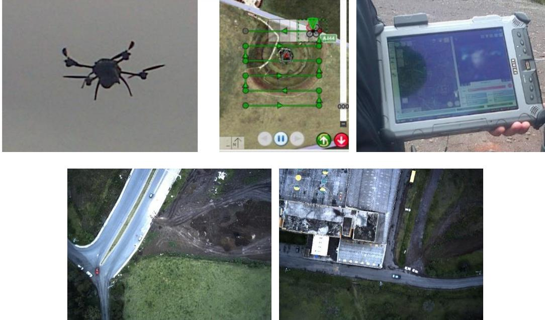
**Fotografías del vuelo, se utilizó el drone Aeryon Scout cuya cámara es de 5 megapíxeles, la altura de vuelo fue de 180 metros de altura, se tomaron 130 fotografías.**
