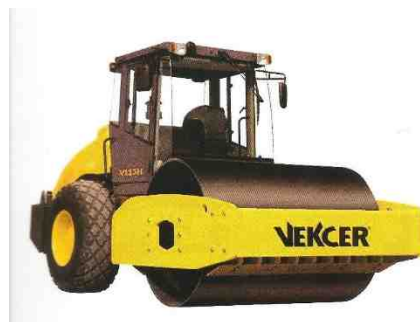
Figura 24: Rodillo vibratorio (Fuente: Autor)
