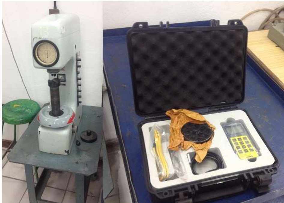
Figura 4.8: “Durómetros mecánico y digital de laboratorio metalúrgico”
