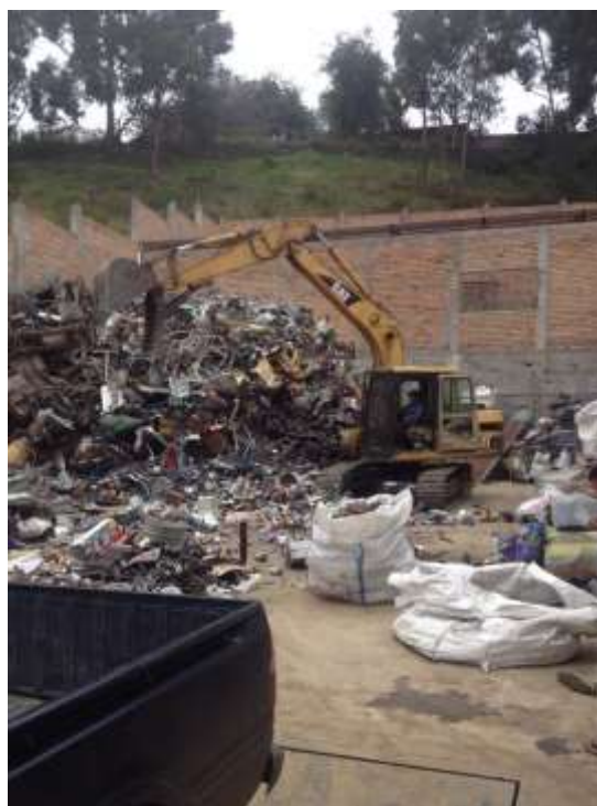
Figura 2.7: “Apilamiento de chatarra por medio de tractor con pinza hidráulica”
