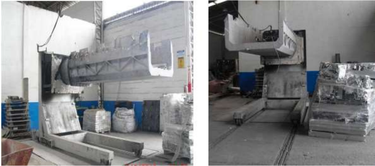
Figura 3.11: “Alimentador tipo bandeja de la planta de fundición Cedal S.A.”
