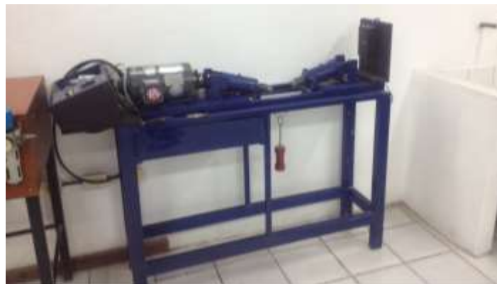
Figura 4.10: “Equipo para comprobar resistencia a la torsión de materiales metálicos”
