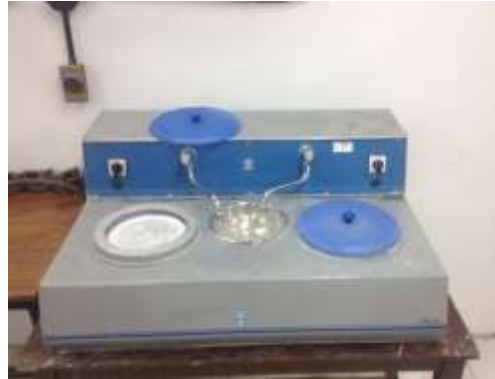
Figura 4.9: “Pulidora de muestras metálicas de laboratorio metalúrgico”
