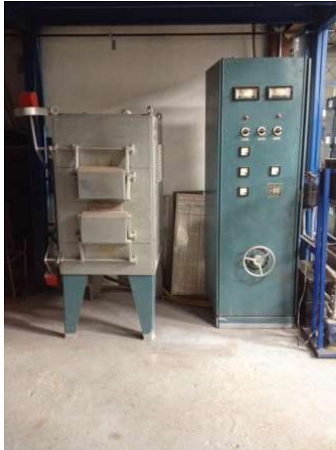
Figura 4.12: “Horno eléctrico para tratamientos térmicos”
