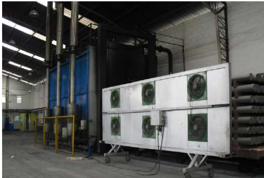
Figura 3.14: “Horno de homogenización para tratamientos superficiales”
