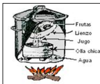
Figura 18: Proceso de extracción por arrastre a vapor.
