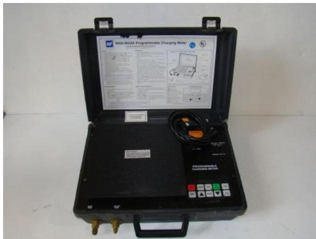
Figura 1.3 Unidad de carga de refrigerante.
