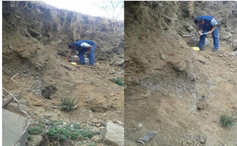
Figura 2.5. Obtención de la densidad de campo.
