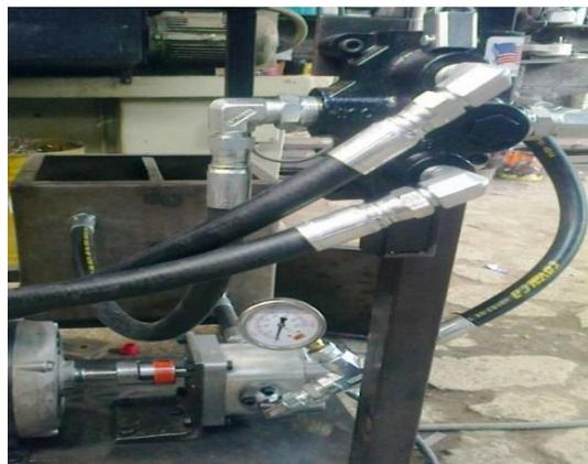
Figura 3. 13 Montaje de la bomba
