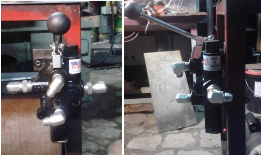
Figura 3. 8. Válvula manual de accionamiento fijada en la estructura
