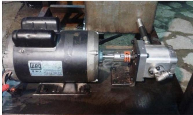
Figura 3. 10 Fijación en la base de la bomba y motor
