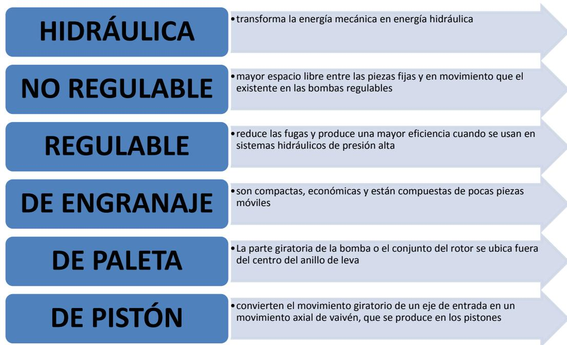
Figura 1. 7 Tipos de bombas y motores
