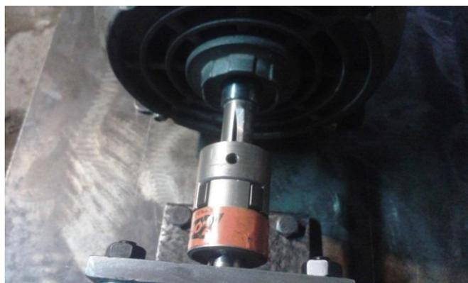
Figura 3. 11. Acople entre bomba y motor
