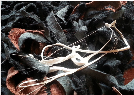
Colocación de la cola sobre los remanentes.
