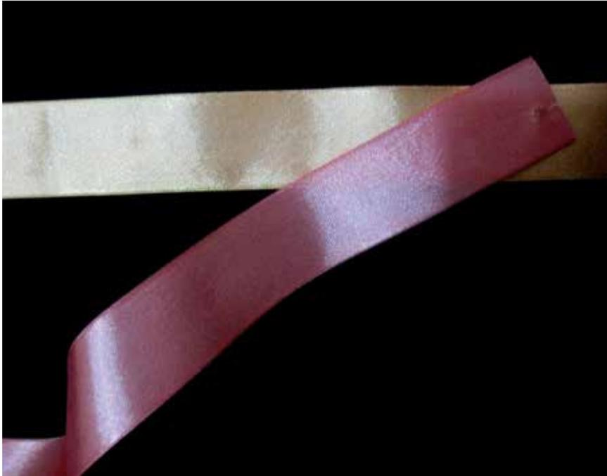
Resultado 185: Decoloración mediante cloro.
