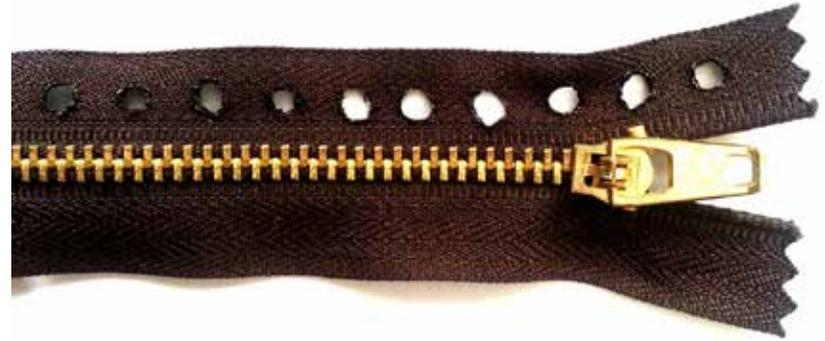
Resultado 2: Perforación o corte con calor.
