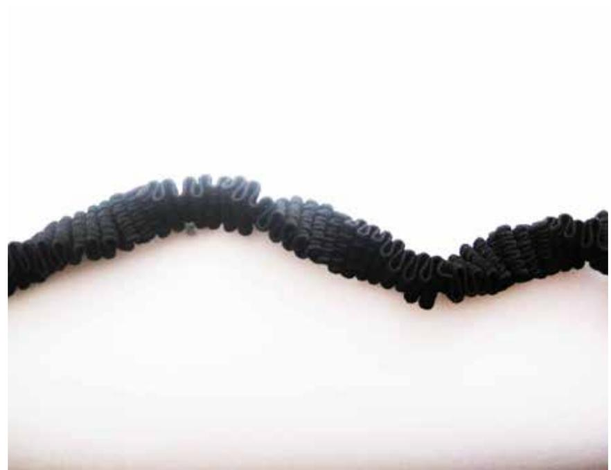
Resultado 128: Encarrujado mediante hilo elástico.
