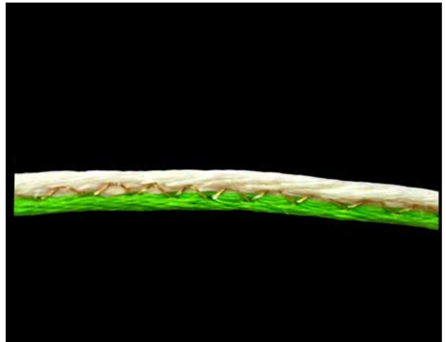
Resultado 75: Costura a máquina, unión de cola de ratón con zigzag.
