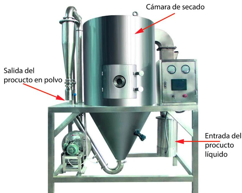
FIG 42. Cámara de secado por atomización
