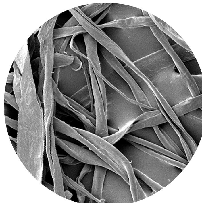
FIG 50. Fibra del algodón bajo microscopio
