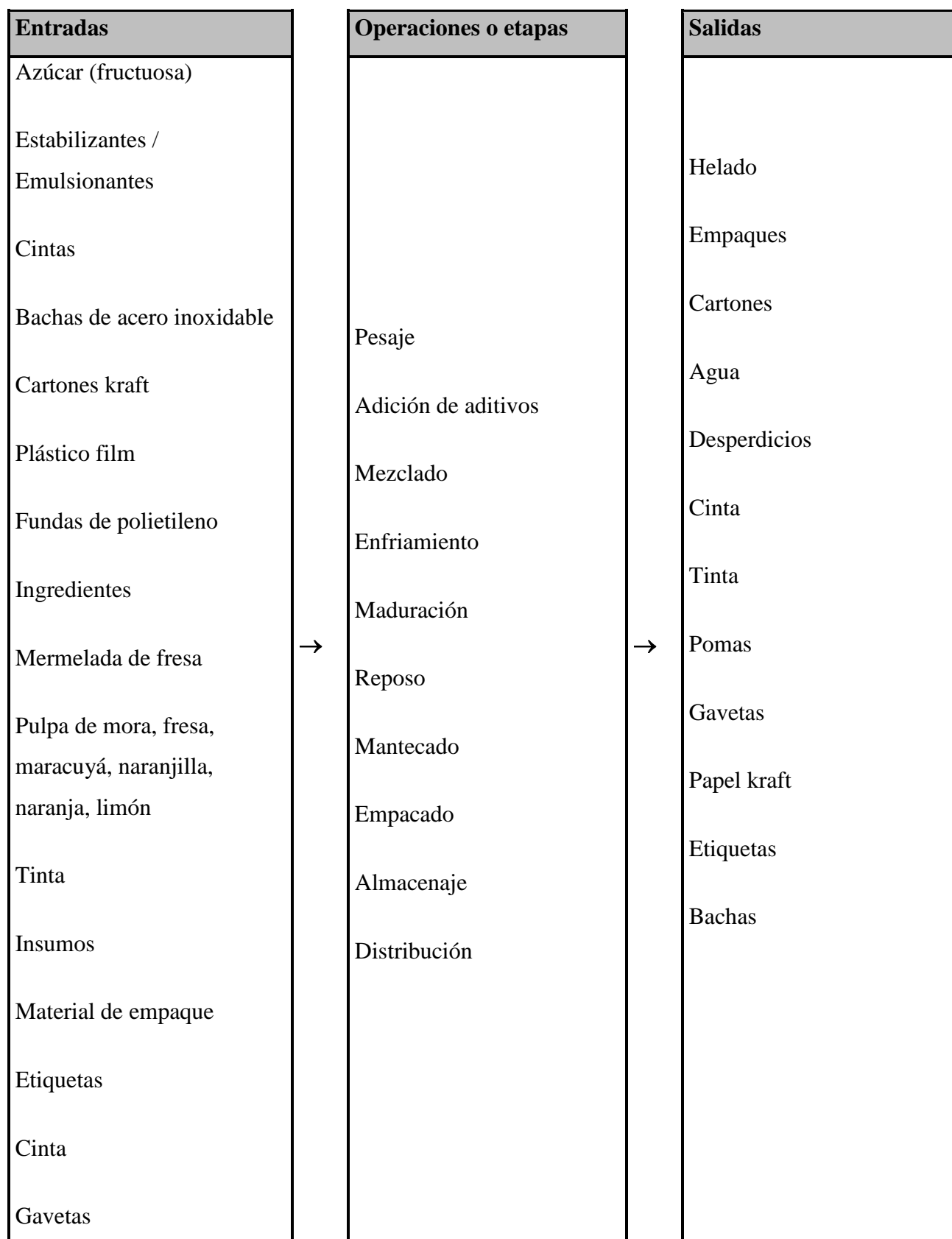
Diagrama 2. Diagrama de entradas y salidas. De “Manual de producción Heladería”, por P. Pulla, s.f. Adaptado por D. Dumas & M. Ochoa.
