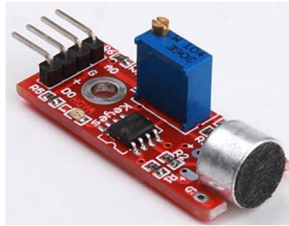
*Ilustración I-24 Modulo Sensor de Micrófono Sensible (Arduino F. , 2014)*
