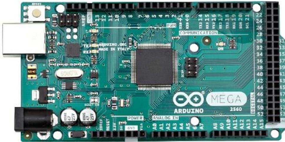
Ilustración I-9 Arduino MEGA (Arduino, 2015)
