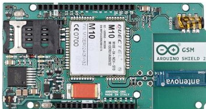
Ilustración I-18 Arduino GSM Shield 2 (Arduino, 2015)
