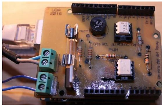
*Ilustración III-8 Conexión Placa control Iluminación PWM*
