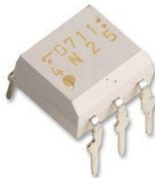
Ilustración II-12 Optoacoplador 4N25 (g7electronica, 2015)
