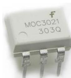
Ilustración II-14 Optoacoplador MOC3021 (Electronicasmd, 2015)
