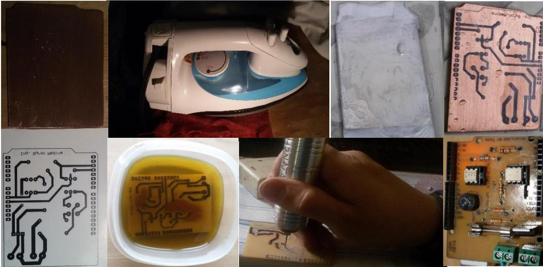
*Ilustración II-25 Proceso para crear la Placa de Circuito Impreso*
