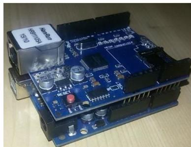
*Ilustración III-5 Arduino UNO y Ethernet Shield*
