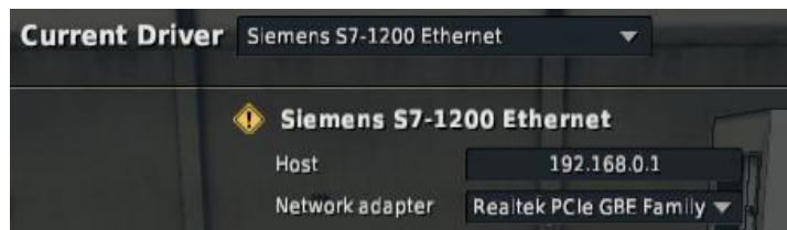
Figura P1.9: Configuración del Driver para Comunicación con el PLC
