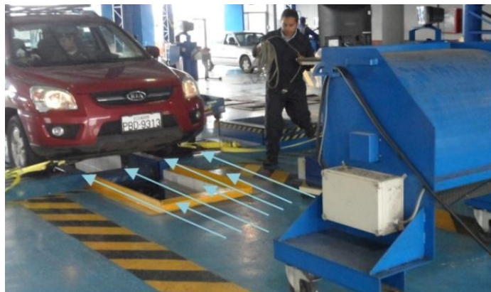
Figura 3.11: Posicionamiento de aire refrigerante
