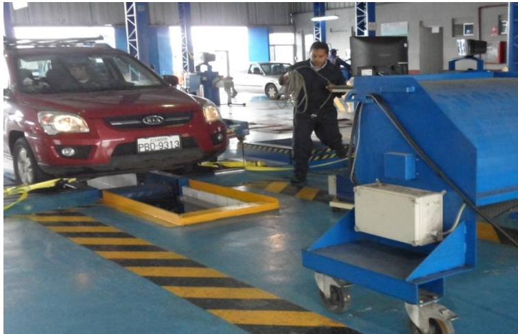
Figura 3.7: Vehículo montado en banco dinamométrico MAHA LPS 3000
