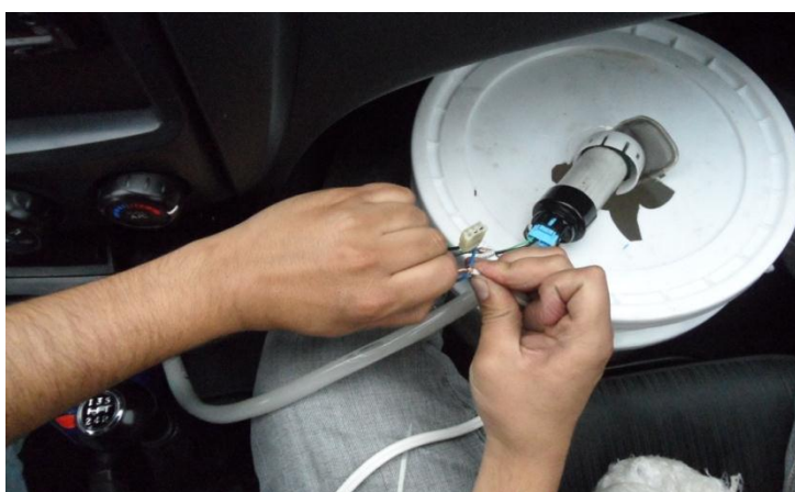
Figura 5.1: Adaptación del sistema de alimentación de combustible
