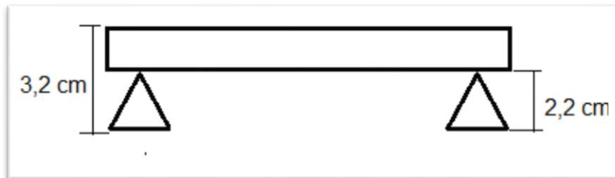
Figura. 2.7. Altura total de la base del Creep Test
