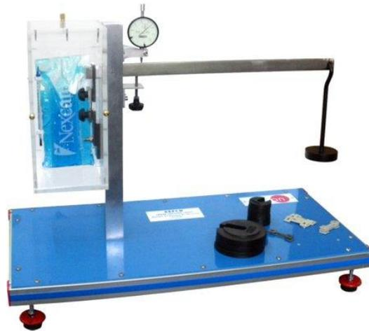
Figura. 1.9. Creep test industrial
