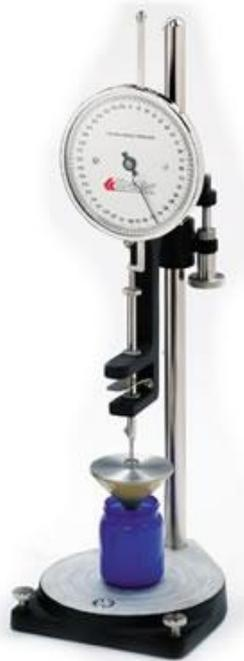
Figura. 1.10. Penetrómetro de cono industrial
