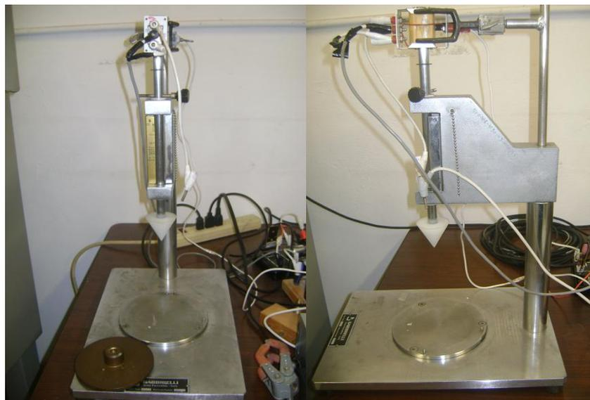
Fig. 2.19. Estructura Nueva del Penetrómetro (Vista Frontal y lateral)
