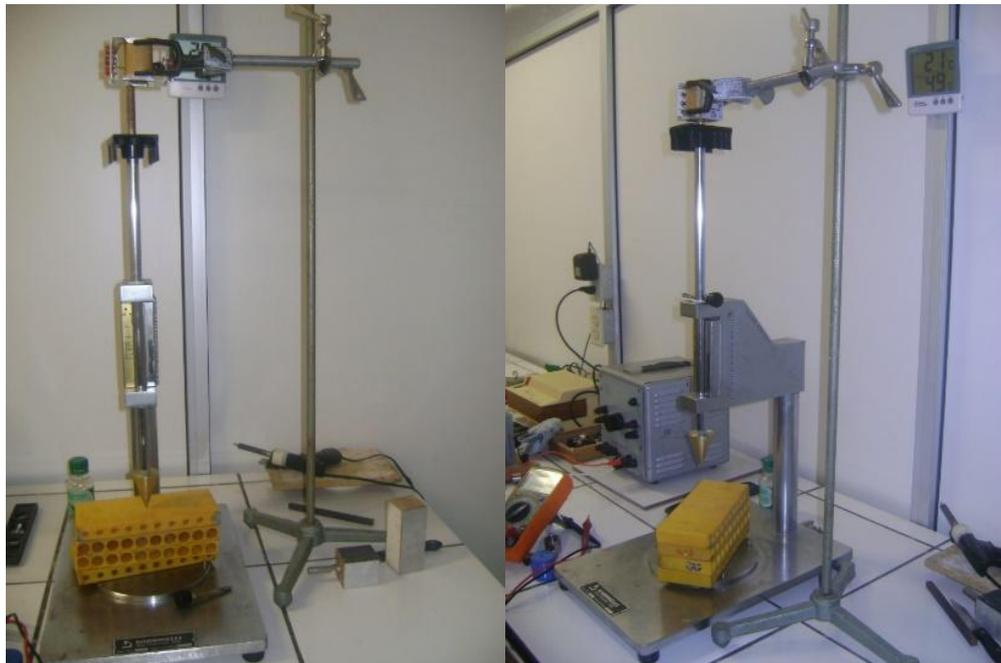
Fig. 2.14. Estructura Antigua Penetrómetro (Vista Frontal y lateral)
