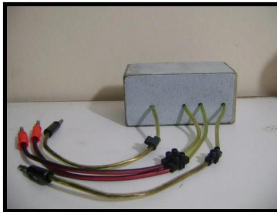
Figura. 3.24. Sensor LVDT del penetrómetro
