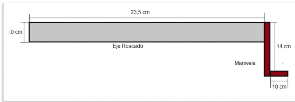
Figura. 2.10. Eje roscado y Manivela
