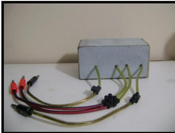
Figura. 3.23. Sensor LVDT del Creep test (Vista lateral)
