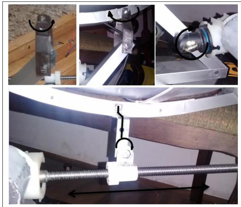
Figura 4.16. Montaje del sistema de seguimiento de elevación
