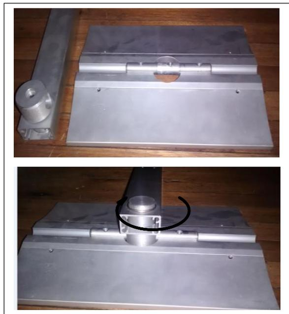
Figura 4.14. Construcción y montaje de la base y estructura soporte
