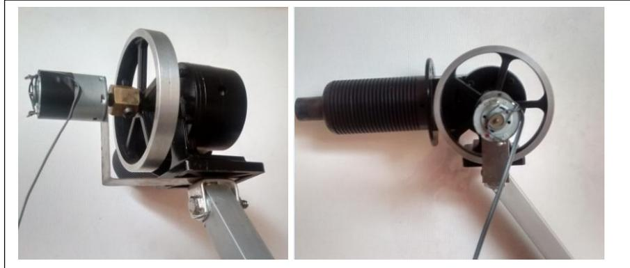
Figura 4.18. Acople de ejes motor y generador
