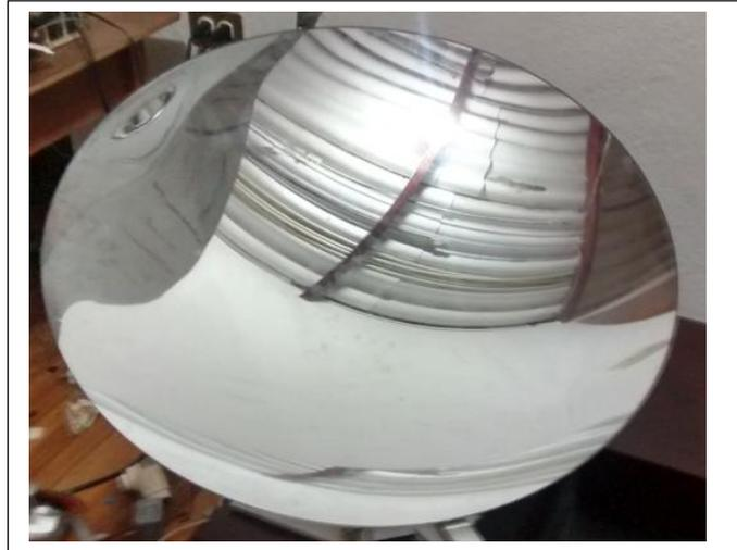
Figura 4.5. Espejo parabólico
