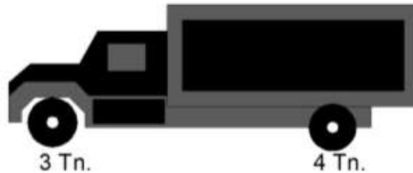
Figura 3.1. Camión seleccionado para el diseño de pavimento.
