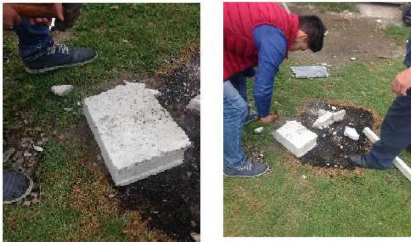
Figura 4-7: Ensayo clavado y aserrado
