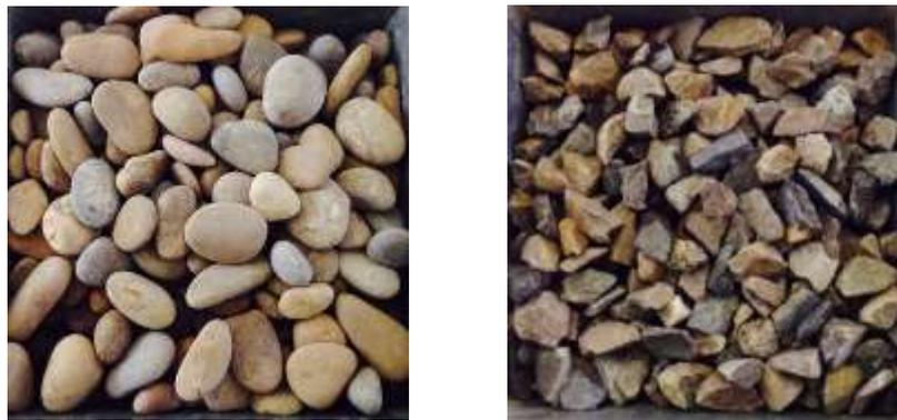
Figura 2-1: Izquierda: Áridos Naturales Derecha: Áridos Procesados
