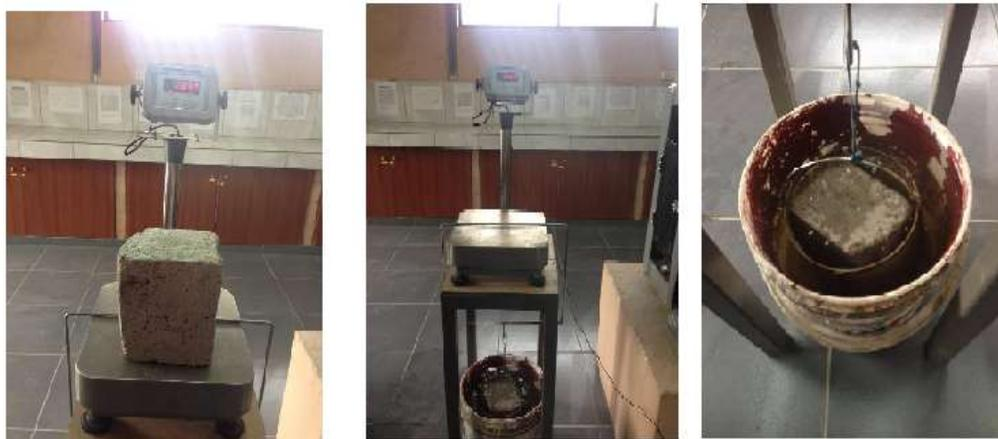
Figura 4-3: Ensayo peso específico y absorción de agua
