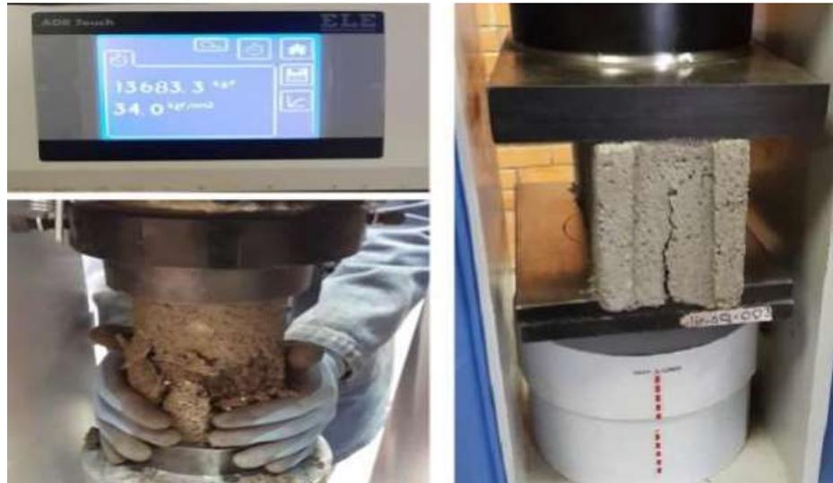
Figura 4-2: Procedimiento del ensayo de compresión.
