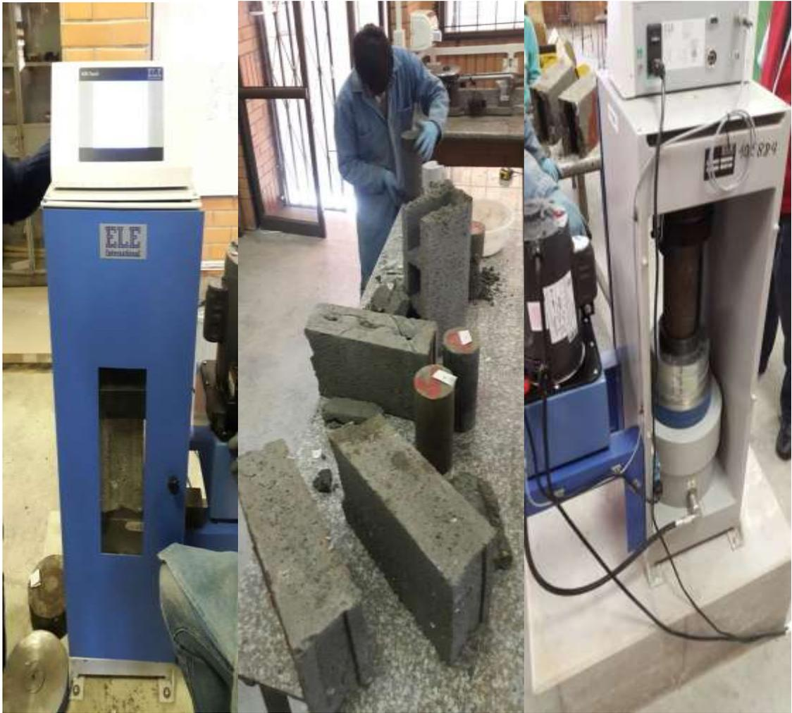
Figura 4-1: Ensayo de Compresión
