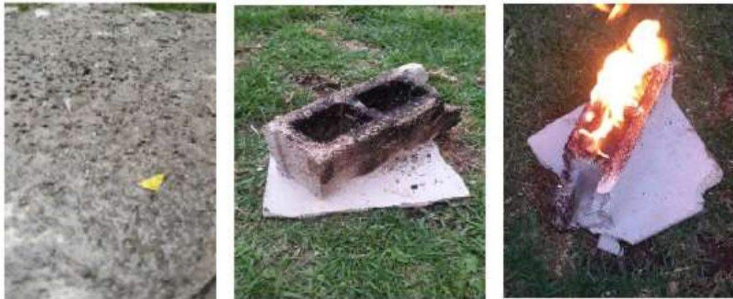
Figura 4-5: Bloque incinerado
