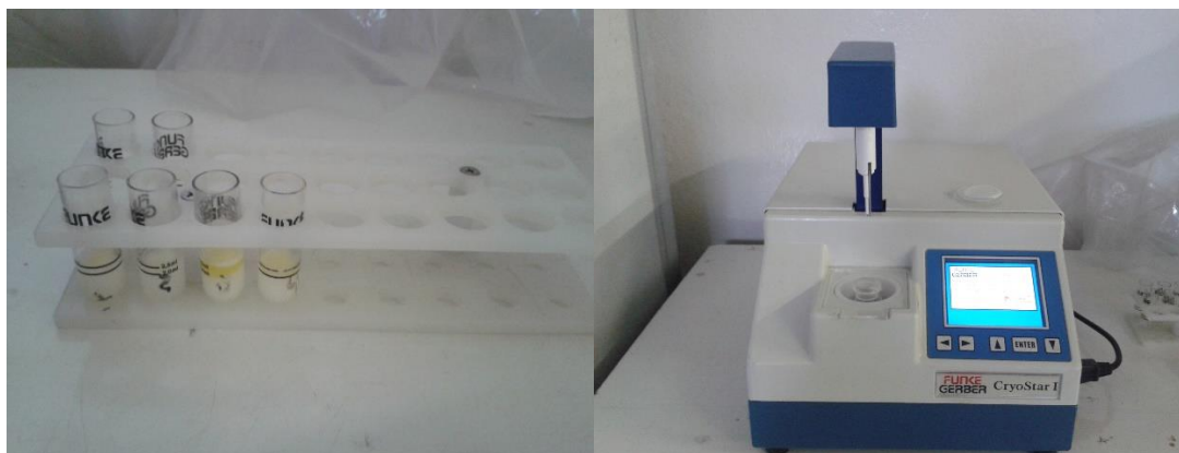
Anexo 10. Cubetas para medir el punto crioscópico y el crioscopio del suero hidrolizado.
