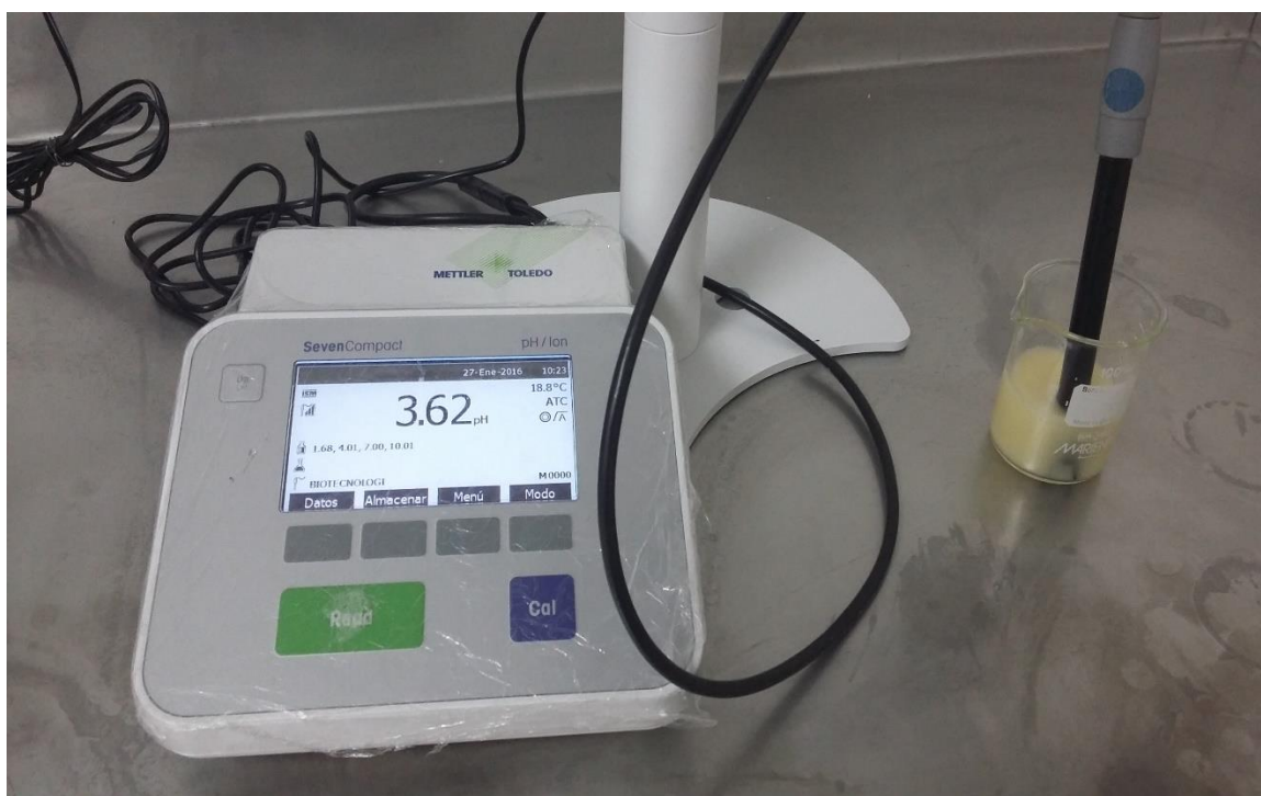
Anexo 24. Medición del pH de la bebida de suero con pulpa de maracuyá.
