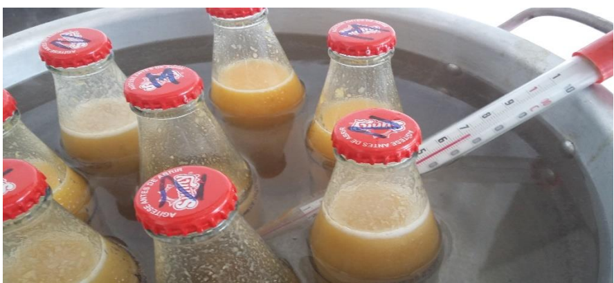
Anexo 27. Pasteurización de las bebidas a 72°C por 15 segundos.
