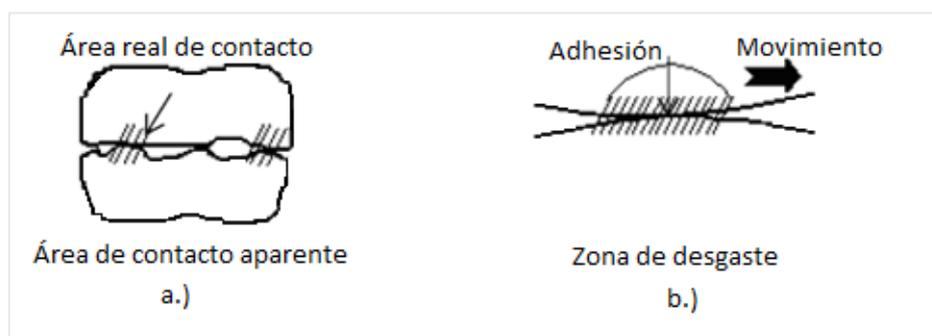
Fig. 1.1.- Desgaste adhesivo entre superficies en contacto: a.- Micro-irregularidades, y b.- Zona de desgaste. Fuente: (Maita, 2007).
