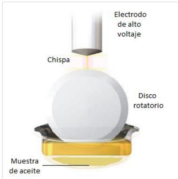
Fig. 2.7.- Espectrómetro por electrodo y disco rotatorio (RDE) Fuente: (Noria Corporation, 2014)
