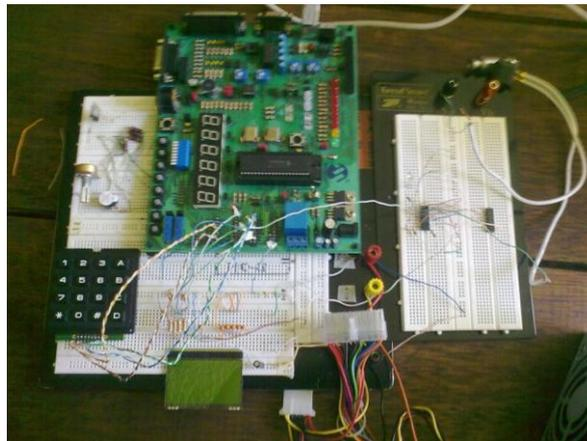
Comprobado el funcionamiento del hardware y el firmware, con las especificaciones planteadas, se procedió a desarrollar los circuitos en tarjetas de cobre para prototipos - véase fig. 3-21 -. En las tarjetas prototipo es necesario ubicar de una manera adecuada los componentes, para poder soldar sin problemas y que las conexiones sigan una cierta secuencia.
