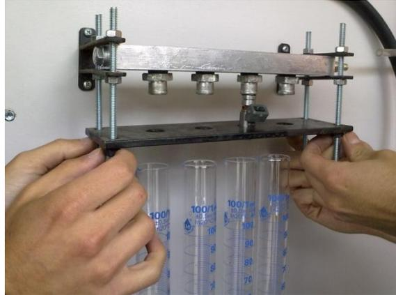
4. Se calibra la altura de las probetas graduadas, de manera que la parte inferior del inyector quedé introducida en las probetas.
