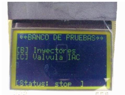
2. Se establecen a continuación los parámetros de prueba - rpm, dirección, paso - por medio del teclado matricial - botones 1, 2, 3 -. Estos parámetros se escogen en base al rendimiento que se desea observar durante el trabajo de la válvula.
