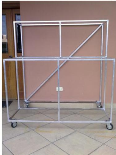
Las zonas laterales y la parte superior de la estructura se cubrieron con láminas de aluminio, mientras que la base se cubrió con latón de 3,175 mm -1/8 pulg- de espesor, este material se adquirió con las medidas y las formas exactas para su instalación a la estructura del banco, la cual se realizó con pernos con punta de broca de 6.36 mm -1/4 pulg- de largo.
