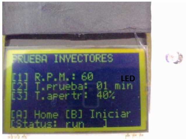
9. Una vez finalizada la prueba - status: stop - se debe apagar la bomba de alimentación del riel, extraer los inyectores, y sacar las probetas para su vaciado.
