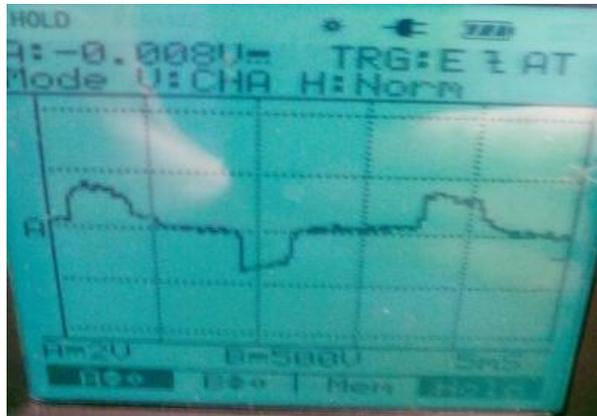
El oscilograma de la fig. 4-54 pertenece a la señal del sensor O<sub>2</sub> del Chevrolet Corsa Evolution.
