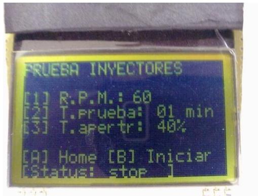
8. Se enciende la bomba de alimentación del riel por medio del interruptor dos, ubicado en el panel de control; a paso seguido, se ejecuta el programa presionando el botón B del teclado matricial, en la pantalla se observa el estado de funcionamiento – status: run – adicionalmente se visualiza los pulsos mediante un led testigo de color azul.
