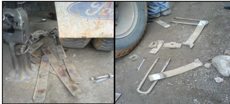
Figura 4.9. Daños de ballestas por sobrecarga
