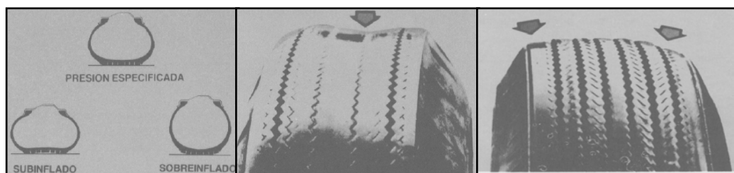
Figuras 4.4. Superficie de contacto, Neumaticos a sobrepresión y subpresión
