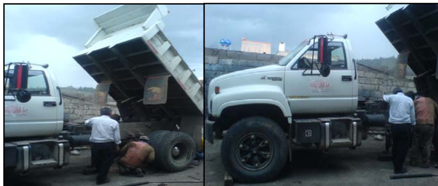
Figura 4.2. Ballesta montada en el Chasis de un vehículo de carga
