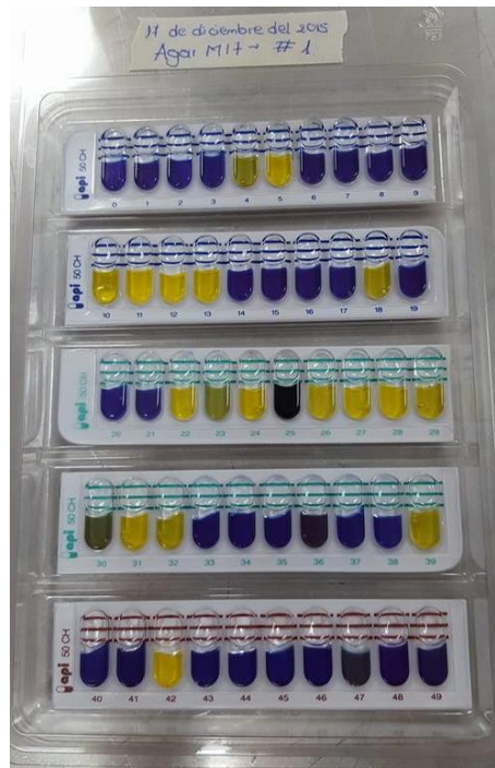
Figura 2.12: Resultado del ensayo de la Galería
