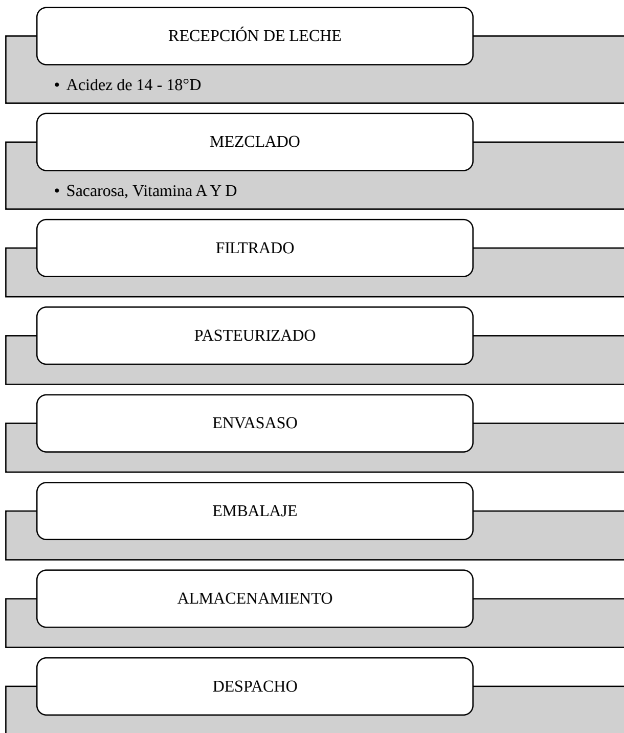
Figura 1.1: Diagrama de flujo de leche pasteurizada
