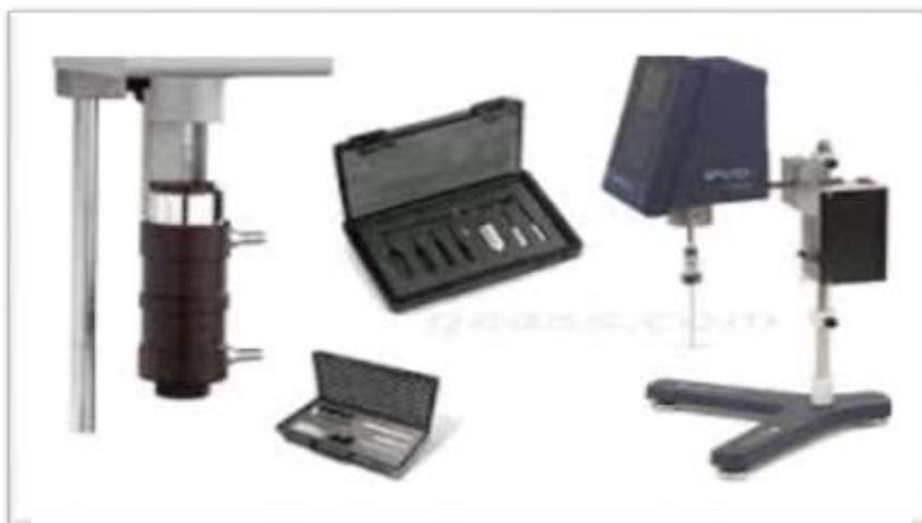
Figura II-1: Viscosímetro rotacional Evo-Expert de Fungilab
