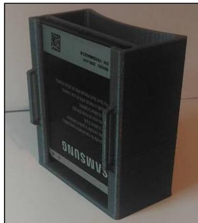
Figura 4.4 Diseño en Inventor de la caja para sostener el circuito
