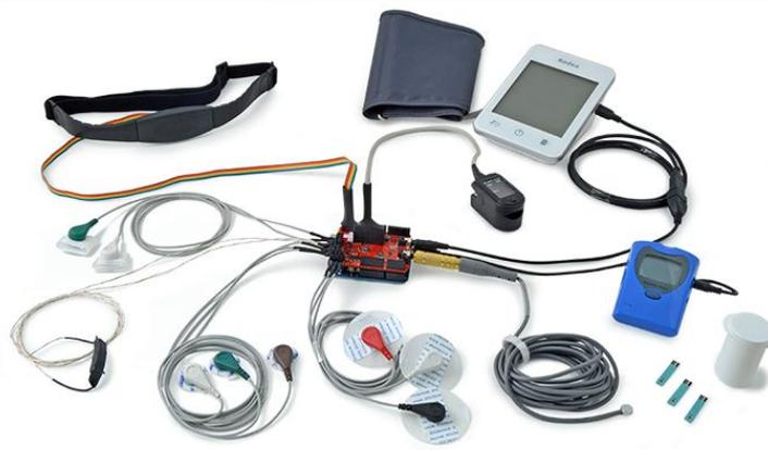
Figura 2.1: Tipos de sensores compatibles con e-Health V2.0.
