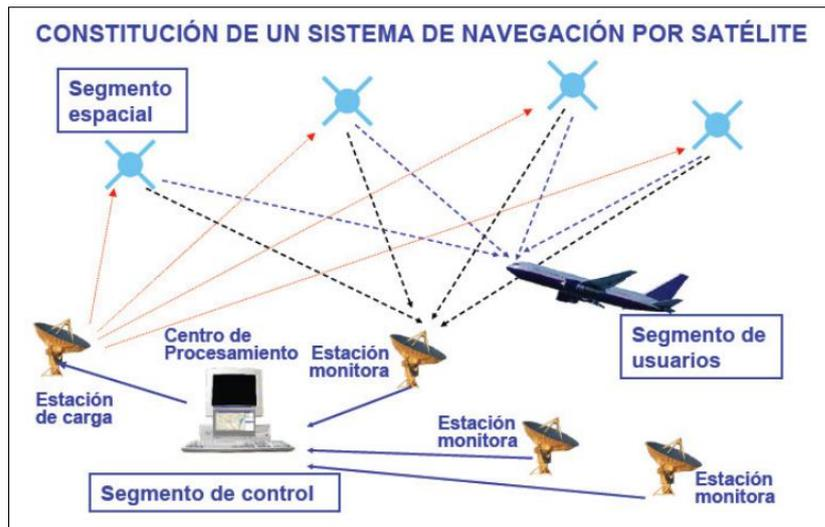
Figura 1.1 Funcionamiento de un Sistema GNSS.
