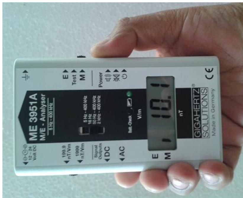
Figura 3. 9. Medición de campo magnético eje Z.
