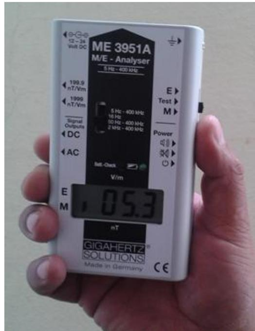
Figura 3. 8. Medición de campo magnético eje Y.
