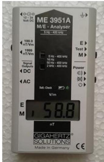
Figura 3. 6. Medición de campo magnético.
