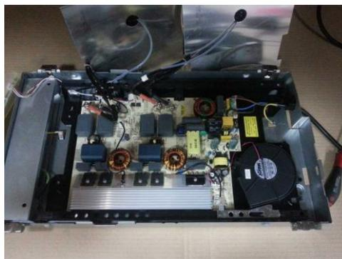
Figura 1. 7. Circuito de potencia de cocina de inducción.
