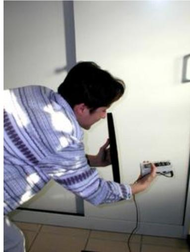
Figura 3. 4. Posición del medidor para evitar alteraciones en las mediciones de campo eléctrico.
