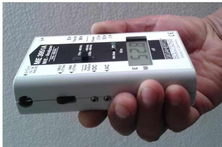
Figura 3. 7. Medición de campo magnético eje X.
