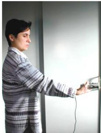
Figura 3. 3. Ubicación incorrecta del medidor para pruebas de campo eléctrico.
