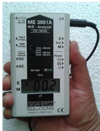
Figura 3. 1. Medición de campos eléctricos.
