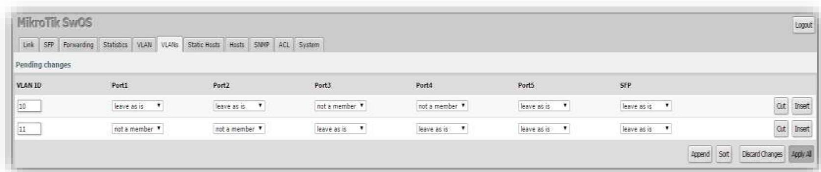
Figura 5.19. Creación de VLANs en MikroTik SwOS.
