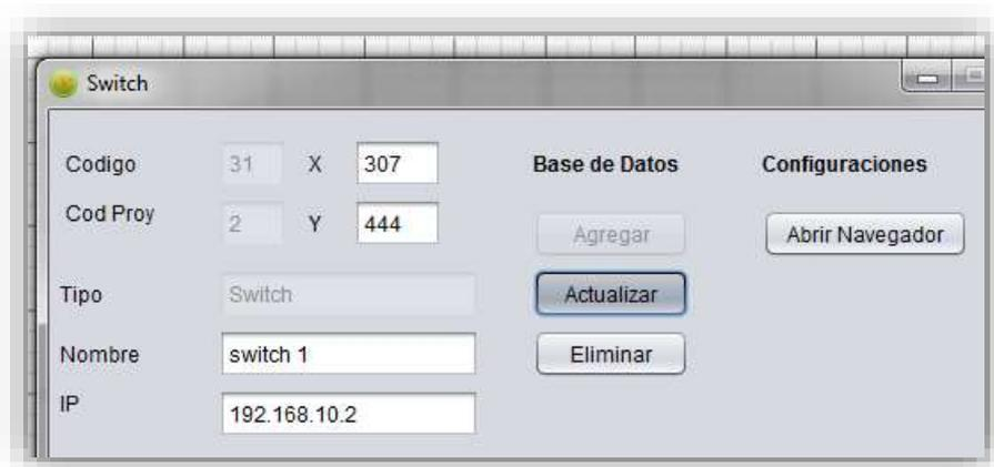
Figura 5.22. Actualización del campo IP del Switch 1.
