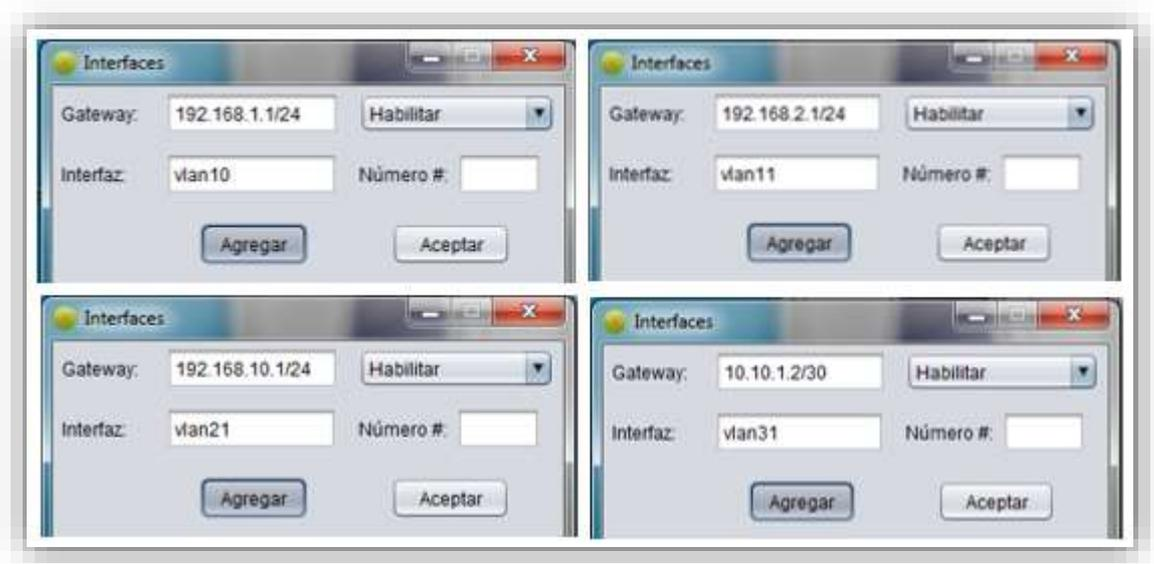
Figura 5.30. Configuración de *gateway* para cada VLAN.
