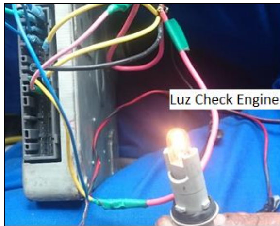
Figura 63. "Alimentación de la ECU, luz Check Engine encendido"
