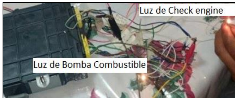
Figura 61. “Luz de Check Engine y bomba de combustible encendido, en Mazda B2200”
