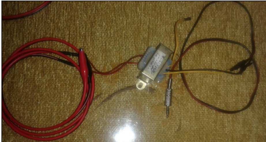
Figura 27. “Transformador de 110 a 12 V”
