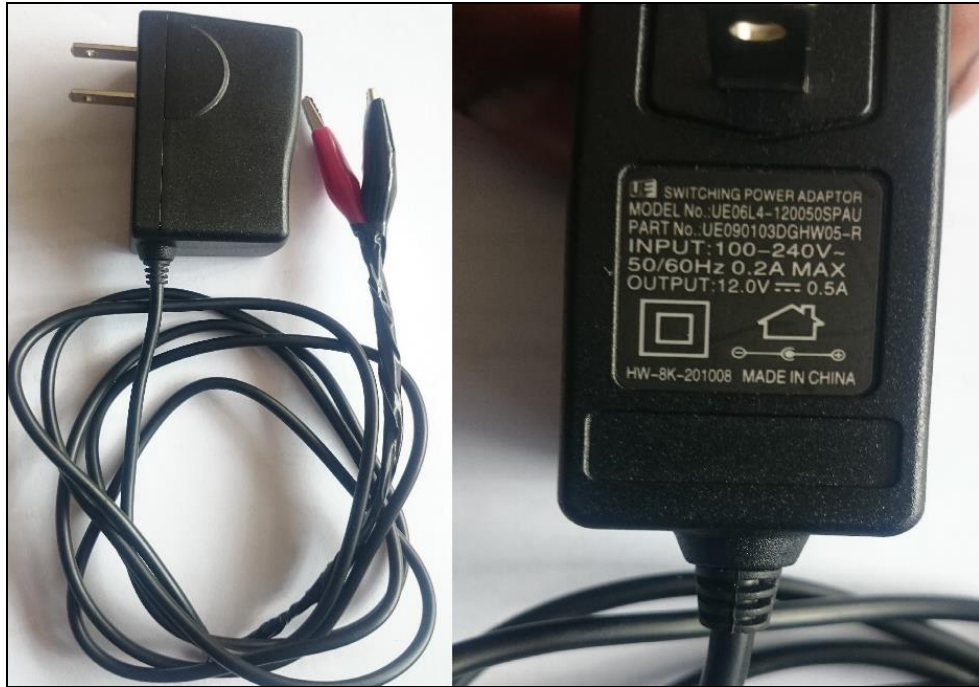
Figura 23. “Fuente de alimentación de 110V AC a 12VDC de 500mA”
