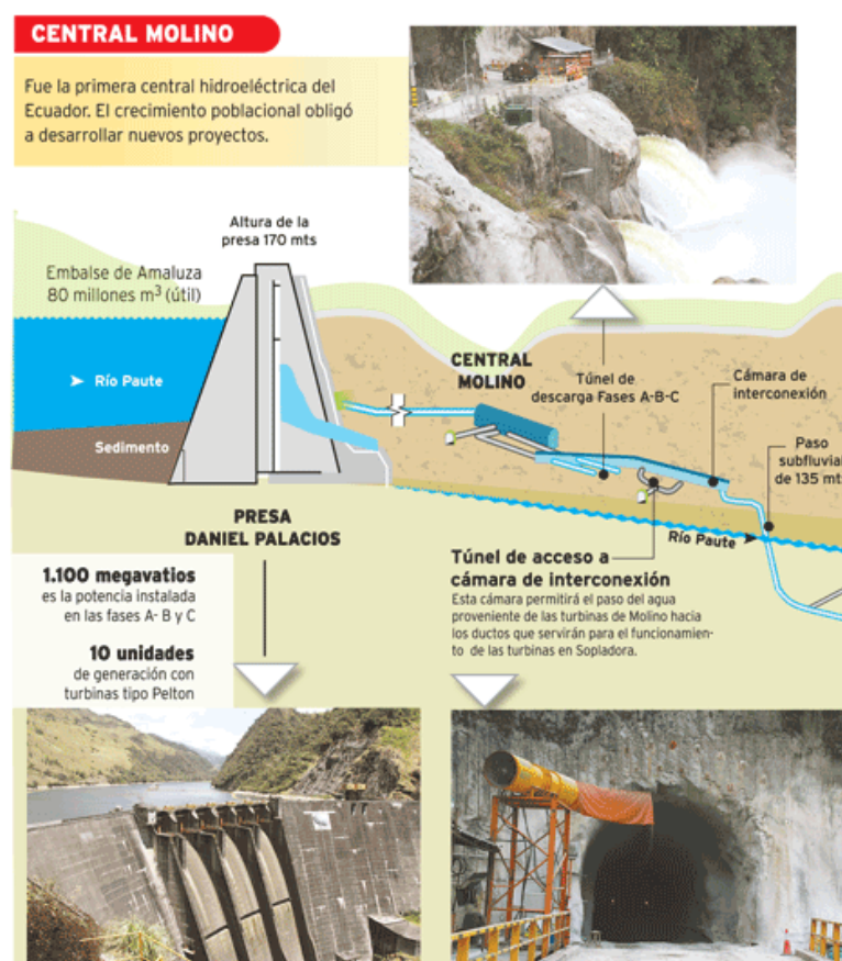
Figura 1.7: Funcionamiento de la Central Molino
