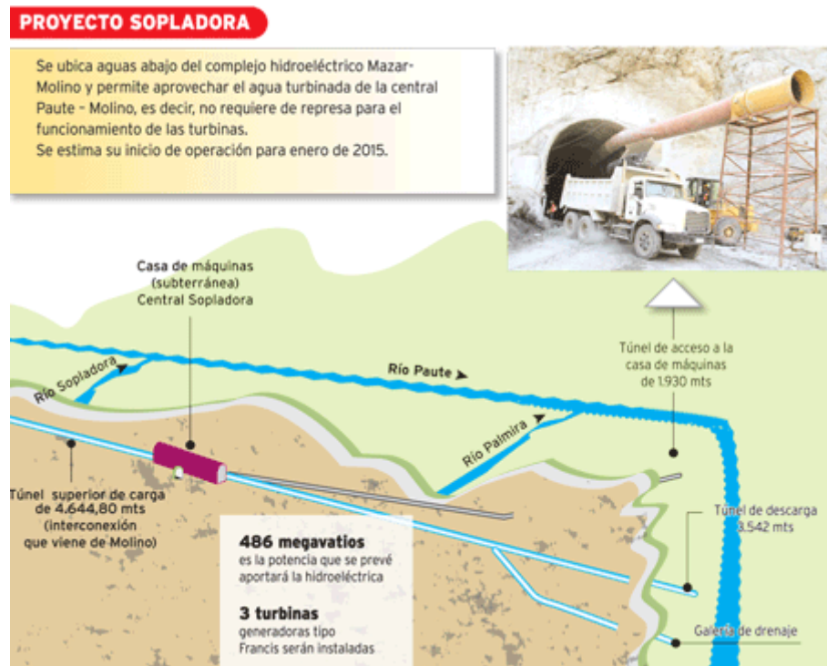
Figura 1.8: Funcionamiento de la tercera fase del complejo: Sopladora
