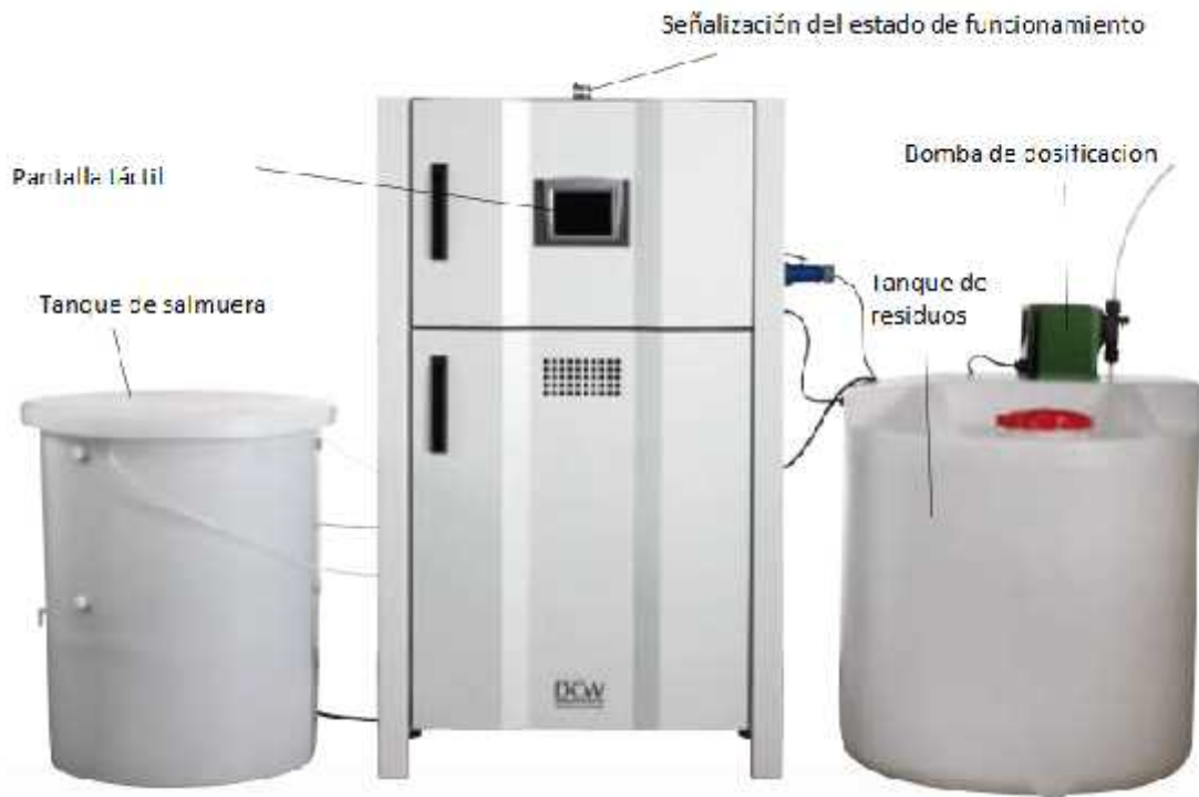
Figura 3.1: Máquina generadora de agua electrolizada
