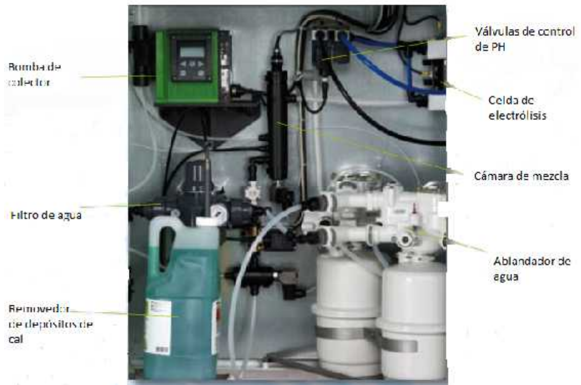
Figura 3.3: Principales componentes para del proceso de la máquina generadora de agua electrolizada
