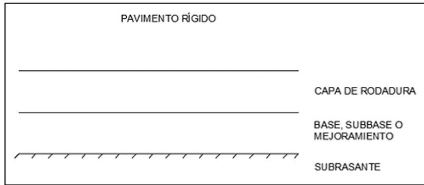
Figura 1.36: Capas del pavimento rígido
