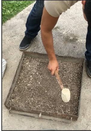
Figura 2.22: Homogenización del suelo
