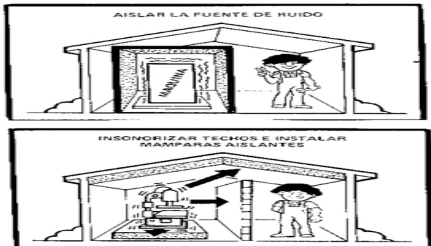
Fig. 6. Ejemplo de insonorización de un cuarto de compresor de aire en un taller o empresa. Fuente, reglamento del Instituto de Seguridad e Higiene laboral España.
