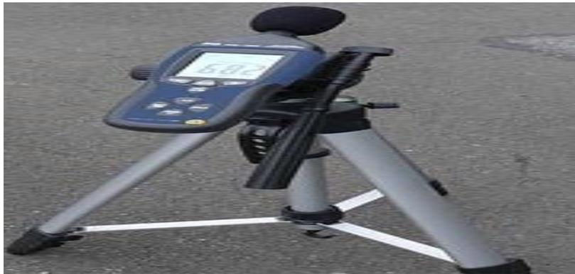
**Fig. 2.** Equipo sonómetro portátil. Fuente, autor
