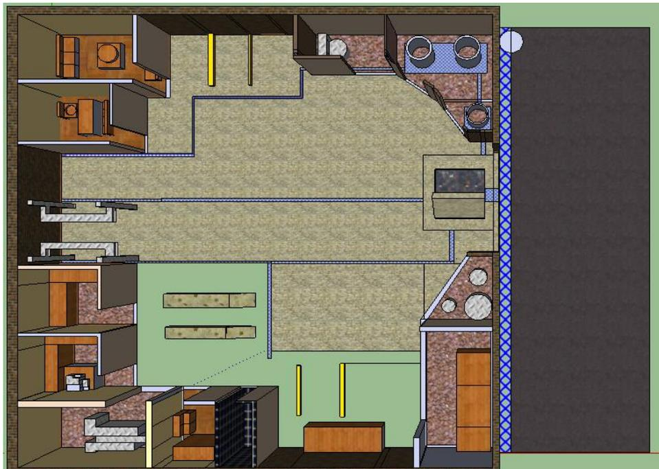
Fig. N. 14 Disposición completa de tuberías y recolector de sólidos. Fuente, autor
