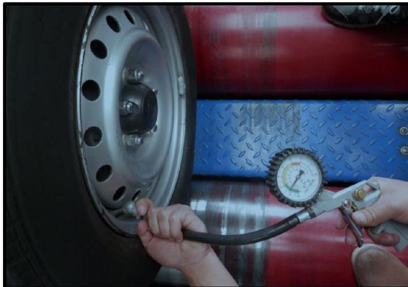
Figura 2.5. Verificación de la presión de los neumáticos
