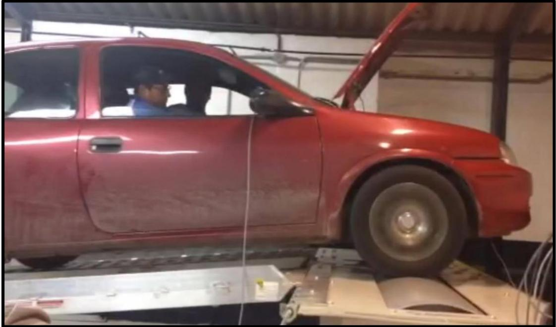
Figura 2.4. Vehículo Corsa Wind sobre el banco dinamométrico.
