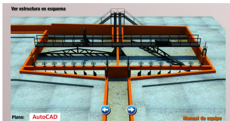
Ilustración 18 Desarenador en vista superior ETAPA EP.
