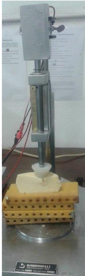
Figura 3.16: Equipo de Penetración con muestra
