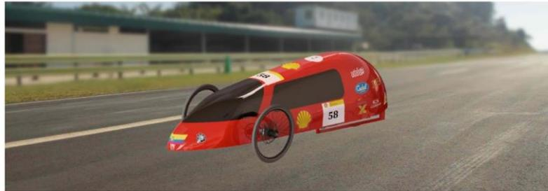
Nuestro vehículo participará en la categoría de propulsión eléctrica, con un chasis construido de aluminio, carrocería aerodinámica de fibra de vidrio y acrílico termoformado. Además, utilizará 3 ruedas (dos frontales y una posterior).
