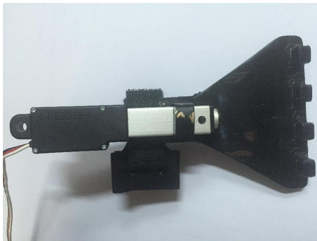
Figura 3.21. Montaje del actuador y la base.
