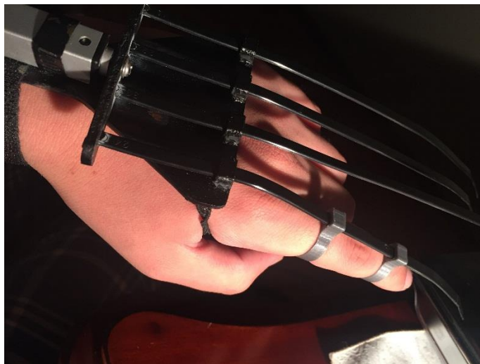
Figura 3.25. Colocación segundo anillo.
