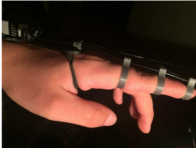
Figura 3.26. Colocación tercer anillo.
