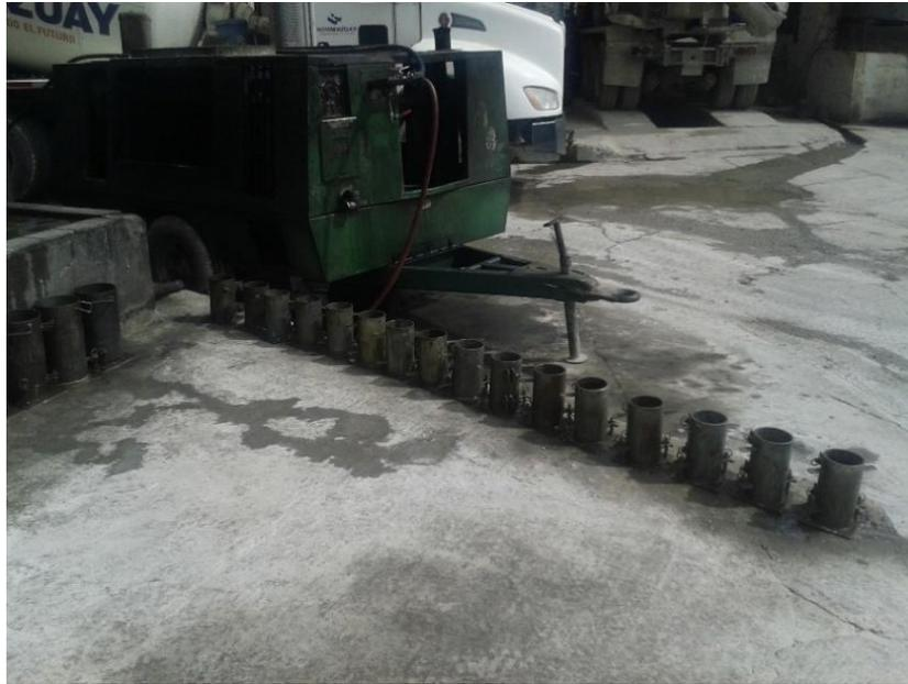
Figura 7: Toma de muestras (cilindros)
