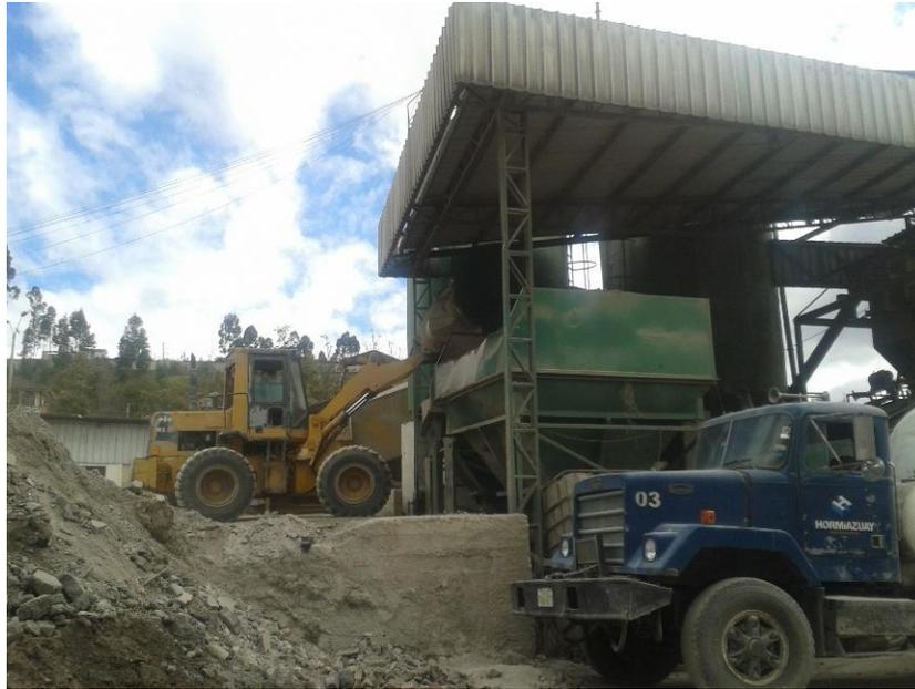
Figura 6: Colocación del material árido en la mezcladora
