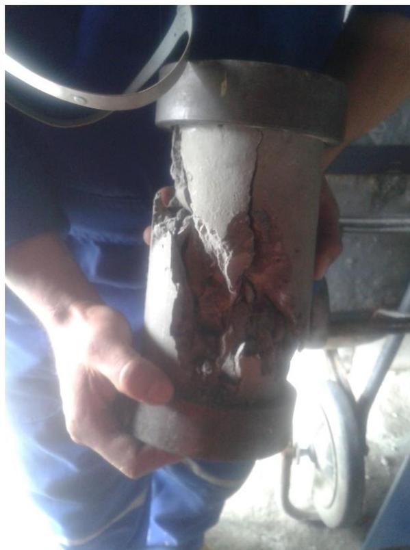
Figura 11: Cilindros, luego de soportar la carga de Rotura
