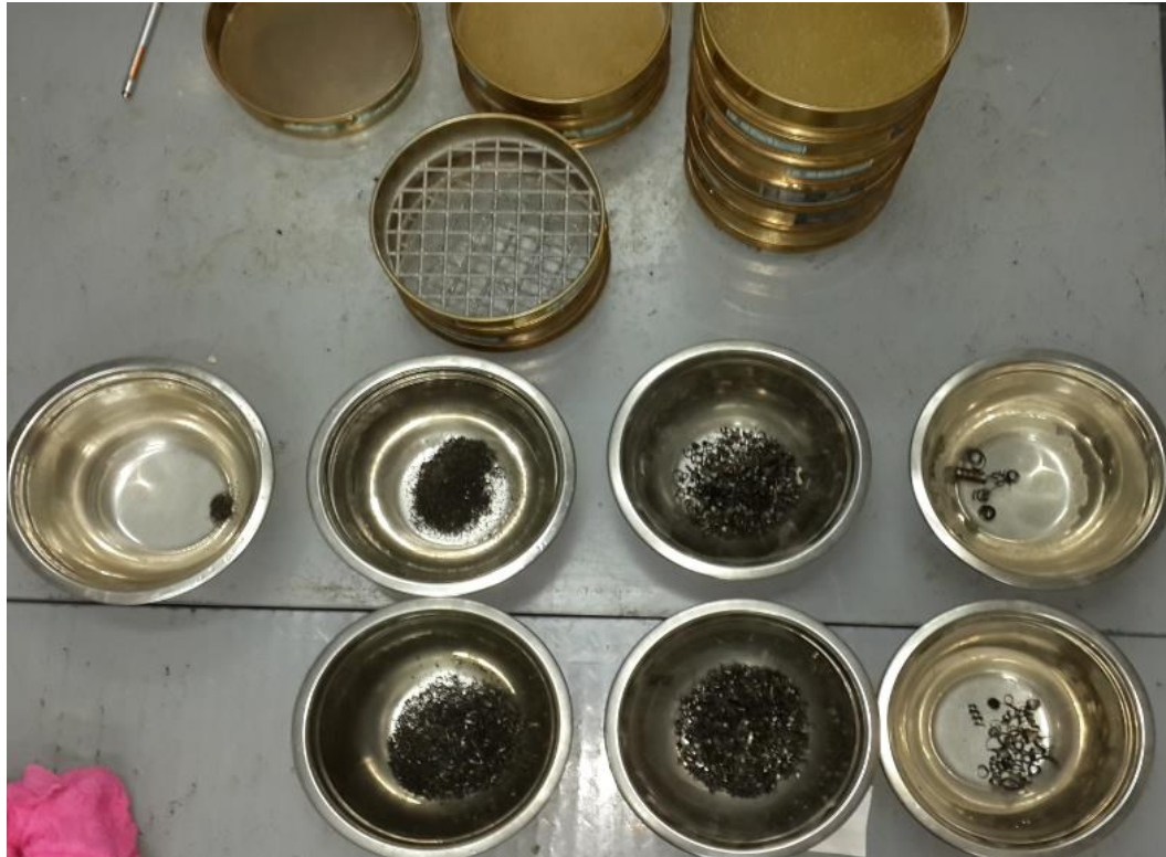
Figura 2.10: Foto granulometría viruta de acero
