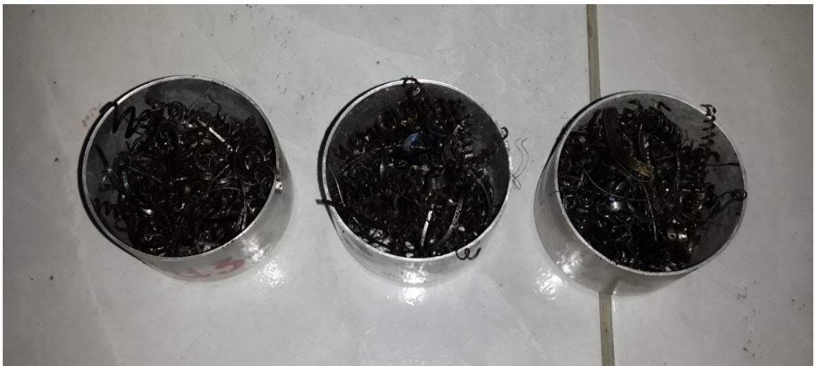
Figura 3.2: Viruta de acero proveniente del taller de torno
