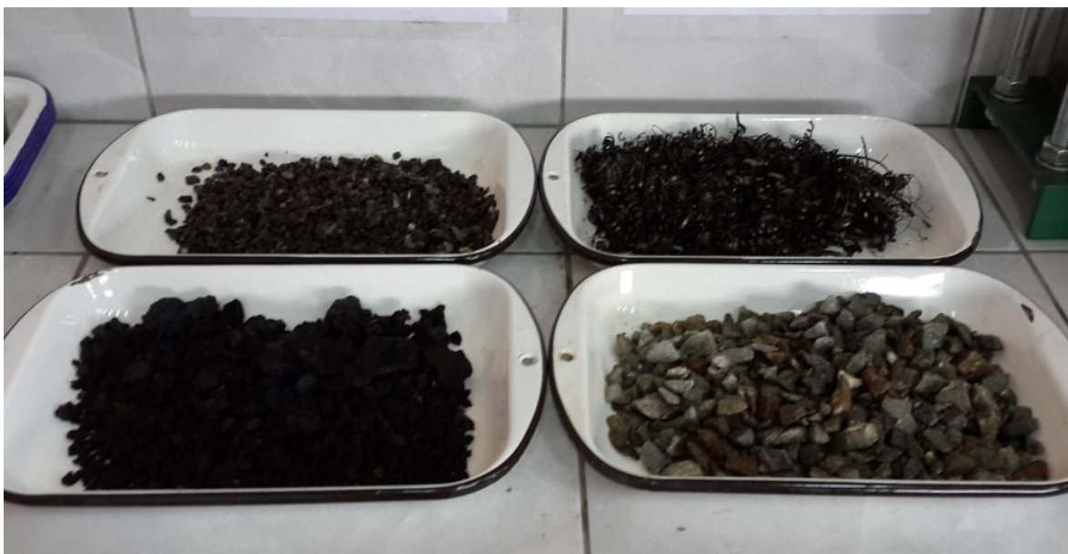
Figura 4.5: Materiales fuera del horno cumplidas las 24 horas
