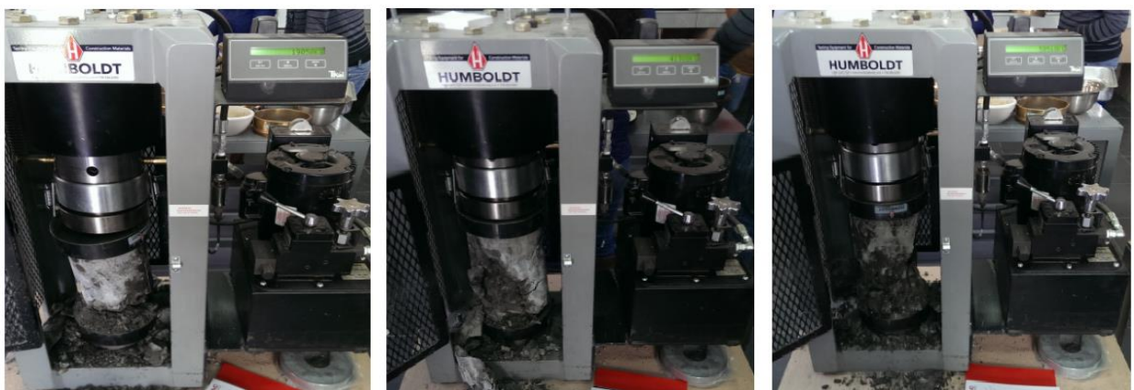
Figura 5.1: Pruebas de compresión
