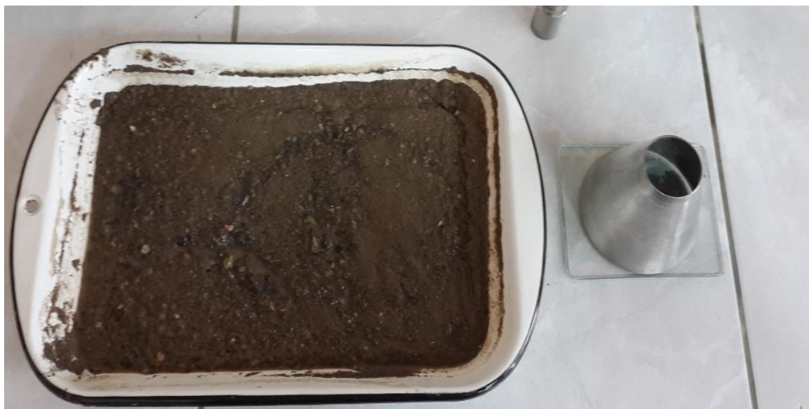
Figura 4.6: Arena saturada de agua por 24 horas antes del análisis de humedad libre
