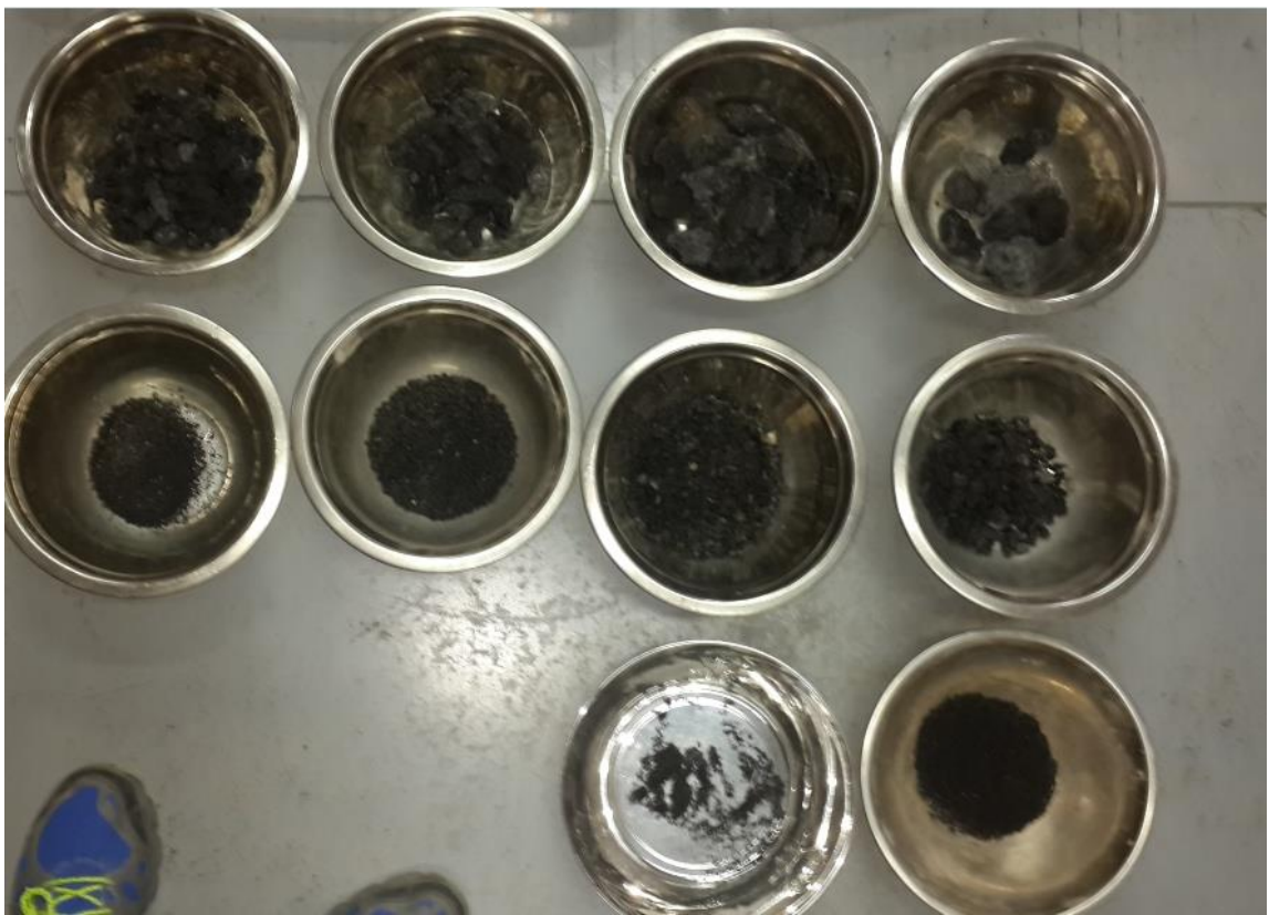
Figura 2.6: Foto granulometría escoria de acero de 1 1/2"
