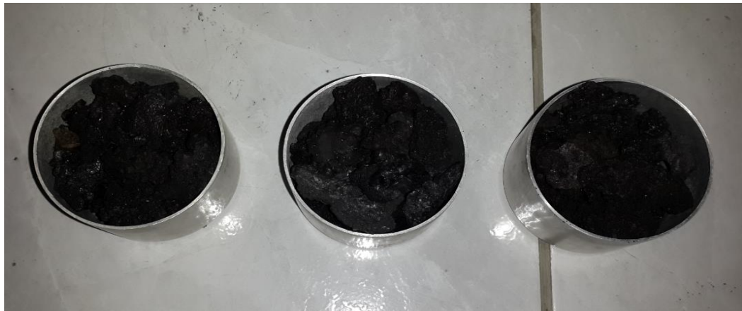
Figura 3.1: Escoria de acero de la fase de fusión
