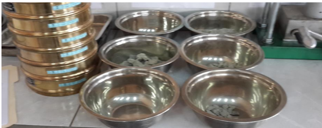
Figura 2.4: Foto granulometría agregado 1 1/2"
