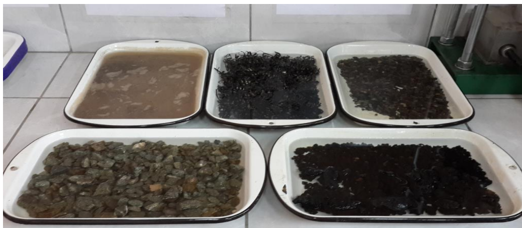
Figura 4.3: Materiales en estado saturado 24 horas
