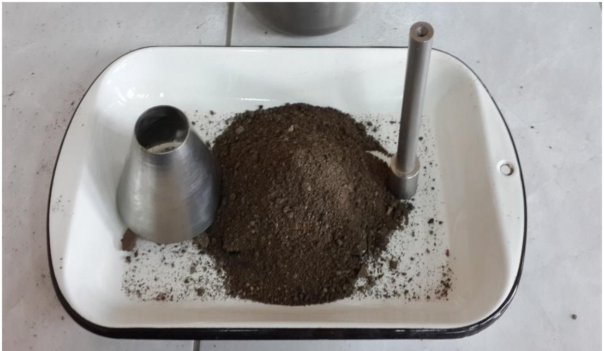
Figura 4.7: Arena en estado saturado superficialmente seco
