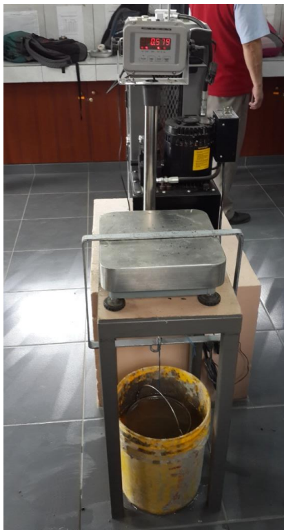
Figura 4.4: Escoria colocada en la canastilla y pesada bajo el agua
