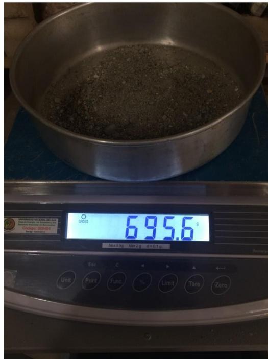
Anexo 10: Peso de la muestra para el ensayo granulométrico
