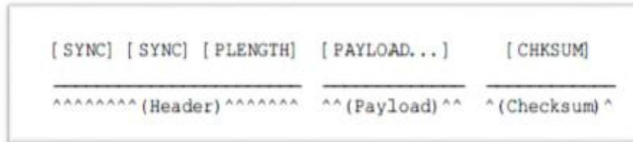
Figura 13.9. Estructura de un paquete del chip TGAM1.
