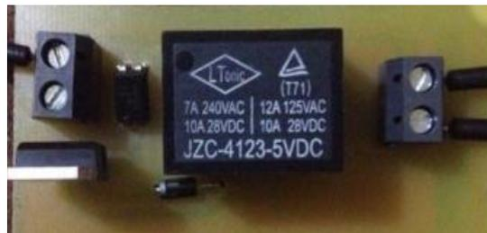
Figura 53.4. Placa Circuito cortador de corriente.
