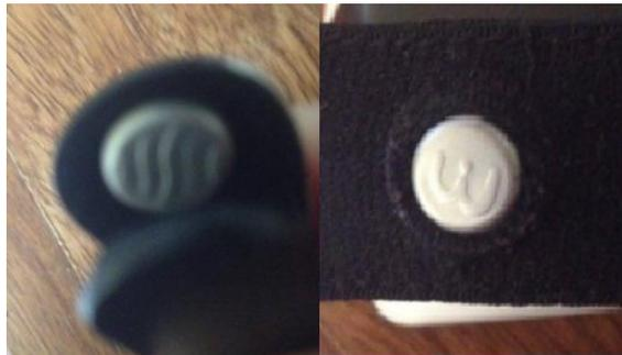
Figura 8.4. Electrodos de Cloruro de Plata.
