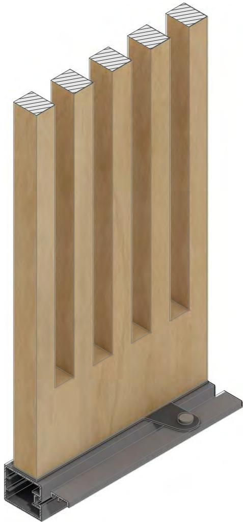
DETALLE EXPLOTADO LAMA PIVOTANTE
