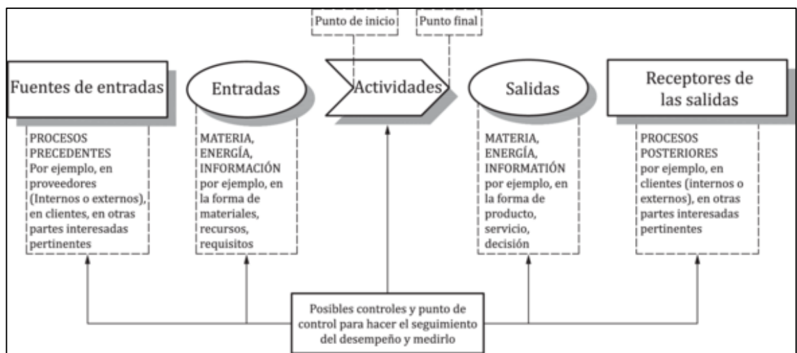
Figura 2.1. Representación esquemática de los elementos de un proceso.
