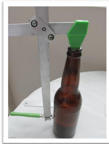
Una vez realizados las marcas de corte en la botella se procede a la fracturación por esta línea de corte y a la separación de las piezas de la botella, uno de los métodos más recomendables para la fracturación es el cambio drástico de temperatura aplicado a la botella.
