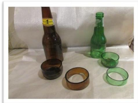
Una vez obtenido los aros de botella se los lleva al horno de vitrofusión para el proceso de fusión total, para este proceso de fundición el horno tendrá que llegar a una temperatura de 820 °C. La pieza para ingresar al horno debe estar libre de impurezas y completamente seca, para evitar posibles defectos en el resultado como por ejemplo la desvitrificación (Beveridge, Doménech, & Pascal, 2006)
