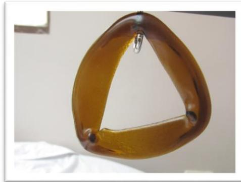
Resultado de un aro de botella cortado transversalmente de la botella de origen y fundido en horno de vitrofusión
