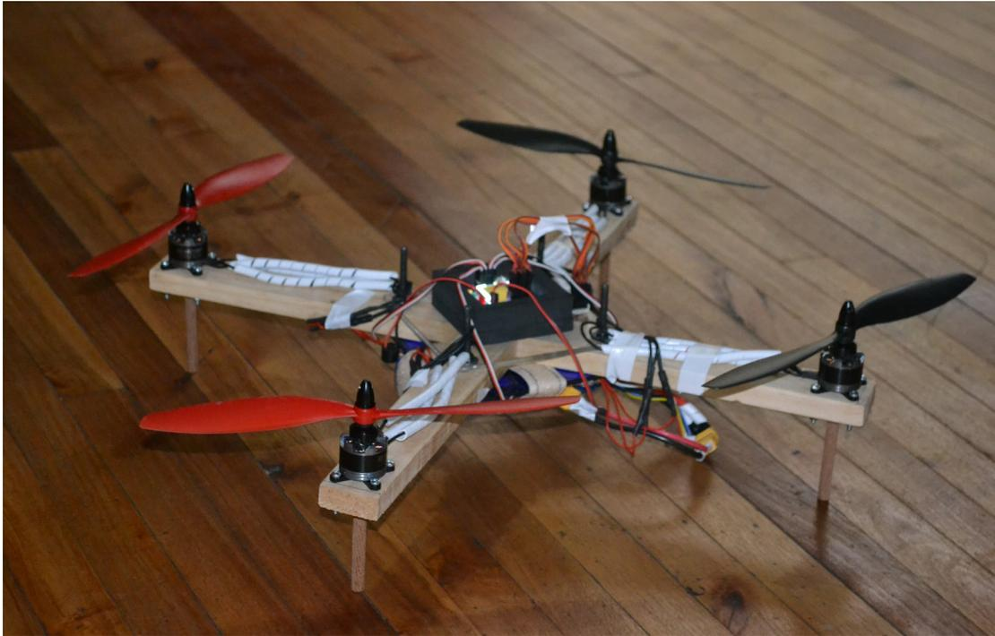
Se desarrolló en madera y láminas de acrílico, para realizar pruebas de vuelo y análisis de los componentes. Con una producción artesanal.
