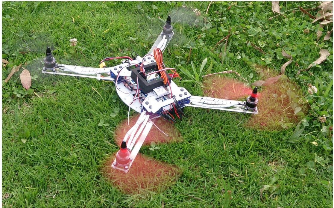
Láminas de acrílico de diferentes espesores, mediante cortes laser, logrando estructurar mediante tornillos la estructura esta célula se desarrolló para un primer estudio de componentes y materialidad en la cual encontramos una carencia de resistencia para los brazos de la estructura.
