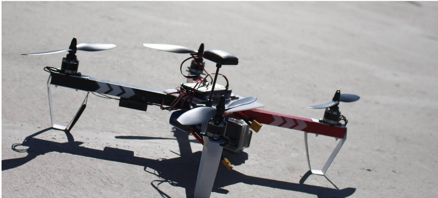
Se desarrolló pruebas en tubo, láminas de aluminio, acrílico e impresión 3D, este prototipo cumplió los parámetros necesarios para realizar pruebas de vuelo, resistencia de materiales y pruebas de los componentes electrónicos. Se efectuaron distintas pruebas de vuelo dentro y fuera de la ciudad obteniendo resultados favorables.
