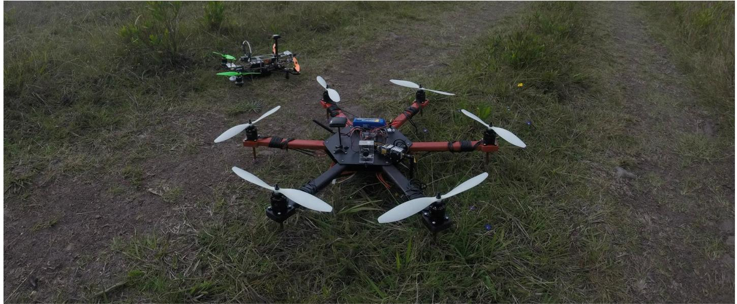
Desarrollo de un multirotor “Hexacopter” con el fin de tener mayor estabilidad en exteriores con velocidades grandes de viento. La Estructura realizada en Madera, láminas de acrílico e impresión 3D fue exitosa al momento de efectuar las correspondientes pruebas de vuelo en las afueras de la ciudad. Pero su mayor consumo de energía generaba un menor tiempo de vuelo.
