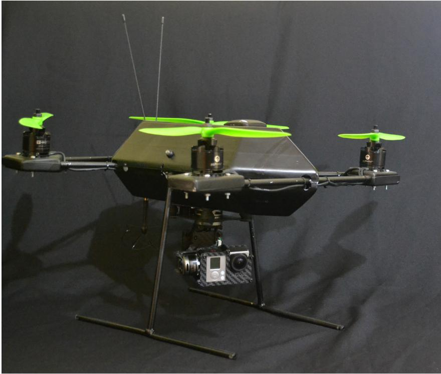
Este prototipo fue la suma de la experiencia adquirida para el desarrollo de un modelo con mayor eficiencia el cual fue elaborado con tubos de aluminio, impresión 3D, plástico termo formado con moldes de madera, este prototipo ha sido de gran ayuda para poder iniciar con los parámetros correctos para estos estudios.
