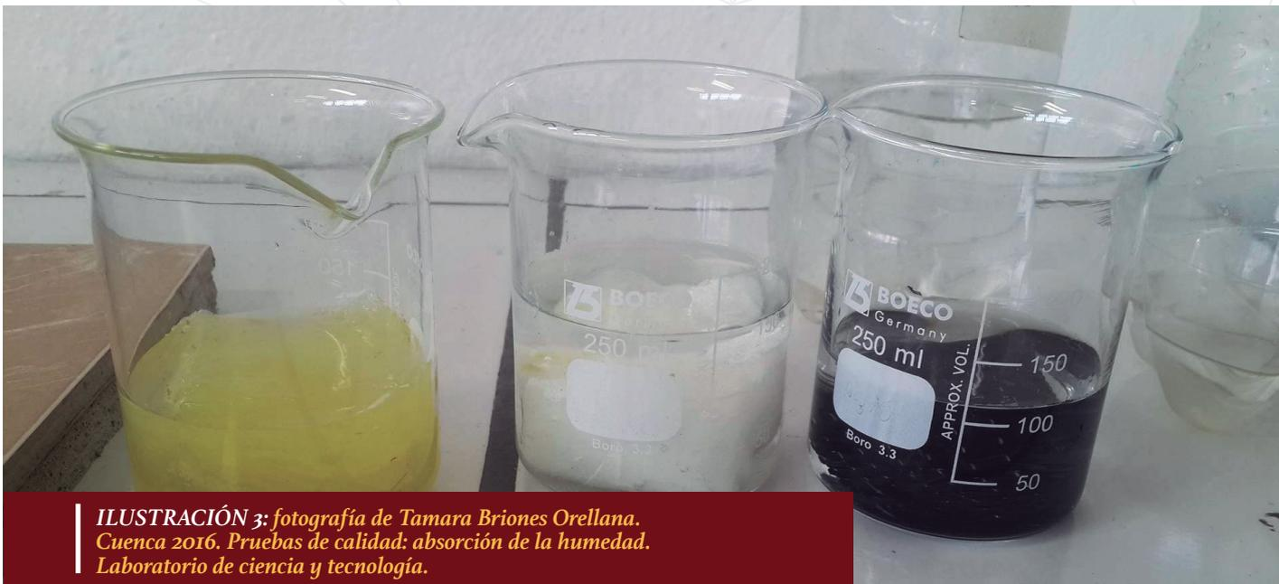
**ILUSTRACIÓN 3:** fotografía de Tamara Briones Orellana. Cuenca 2016. Pruebas de calidad: absorción de la humedad. Laboratorio de ciencia y tecnología.
