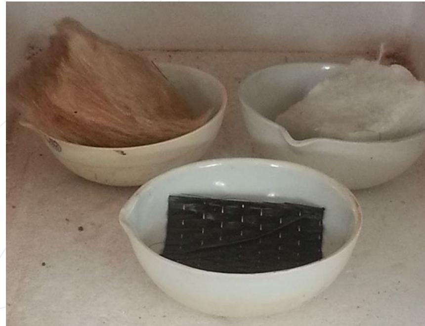
**ILUSTRACIÓN 8:** Fotografía De Tamara Briones Orellana. Cuenca 2016. Pruebas De Calidad: Resistencia Al Calor En La Mufla. 300°. Laboratorio De Ciencia Y Tecnología.
