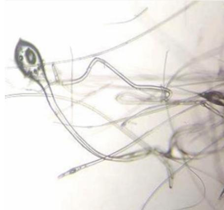
*Ilustración 15:* Fotografía de Tamara Briones Orellana. Cuenca 2016. Pruebas de calidad: análisis microscópico, lana de vidrio.
