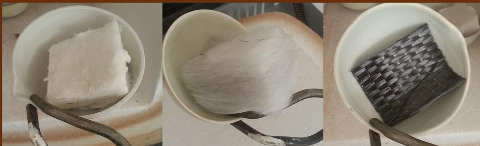
**ILUSTRACIÓN 10:** Fotografía de Tamara Briones Orellana. Cuenca 2016. Pruebas de calidad: resistencia al calor en la mufla. 500°. Laboratorio de ciencia y tecnología.
