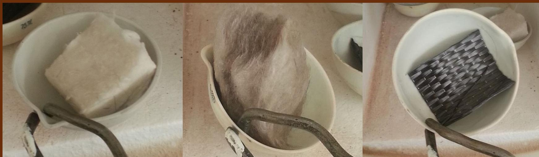
**Ilustración 9:** fotografía de Tamara Briones Orellana. Cuenca 2016. Pruebas de calidad: resistencia al calor en la mufla. 400°. Laboratorio de ciencia y tecnología.
