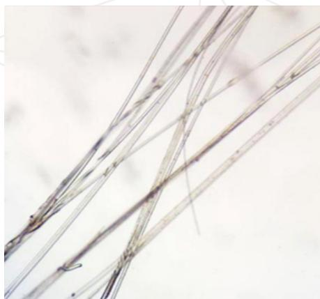
**Ilustración 23:** Fotografía de Tamara Briones Orellana. Cuenca 2016. Pruebas de calidad: análisis microscópico, lana de cerámica.
