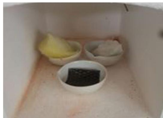
**ILUSTRACIÓN 6:** Fotografía de Tamara Briones Orellana. Cuenca 2016. Pruebas de calidad: resistencia al calor en la mufla. Laboratorio de ciencia y tecnología. químicas.
