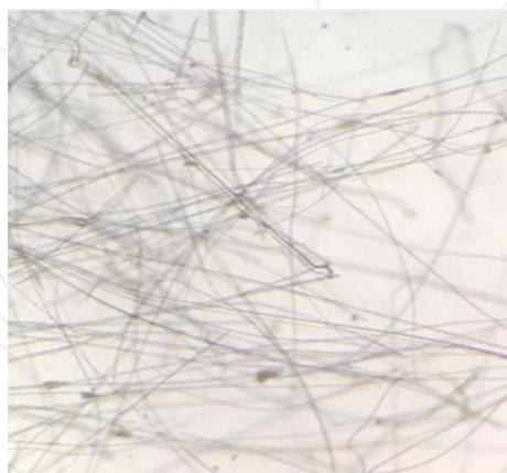
**Ilustración 24:** Fotografía de Tamara Briones Orellana. Cuenca 2016. Pruebas de calidad: análisis microscópico, lana de vidrio.
