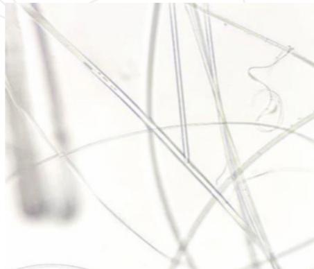
*Ilustración 12:* Fotografía de Tamara Briones Orellana. Cuenca 2016. Pruebas de calidad: análisis microscópico, lana de vidrio pura.
