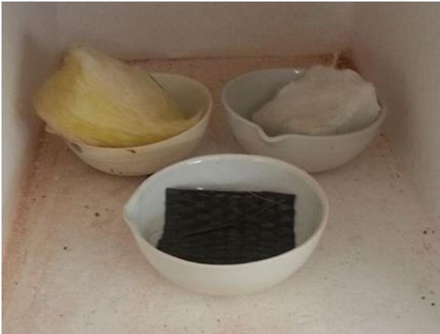
**ILUSTRACIÓN 7:** Fotografía De Tamara Briones Orellana. Cuenca 2016. Pruebas De Calidad: Resistencia Al Calor En La Mufla. 150°. Laboratorio De Ciencia Y Tecnología.
