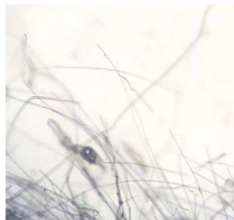
*Ilustración 18:* Fotografía de Tamara Briones Orellana. Cuenca 2016. Pruebas de calidad: análisis microscópico, lana de vidrio.
